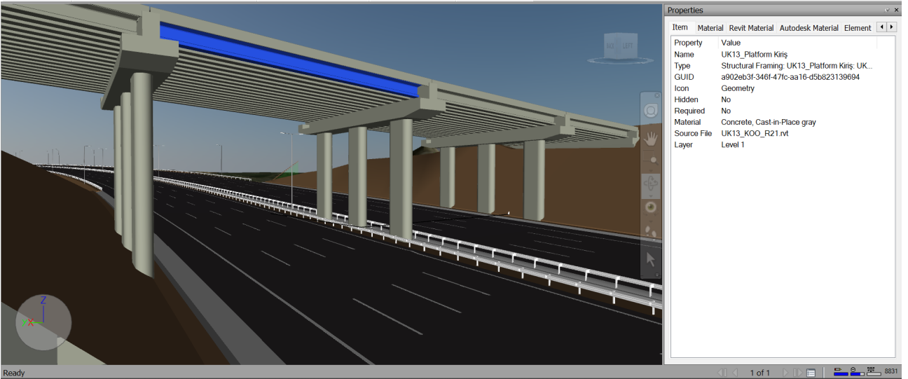
Şekil 4.19: Sanat yapıları- üst geçit köprüsü kiriş modeli.
