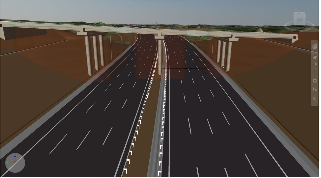
Şekil 4.18: Sanat yapıları- üst geçit köprüsü modeli-2.
