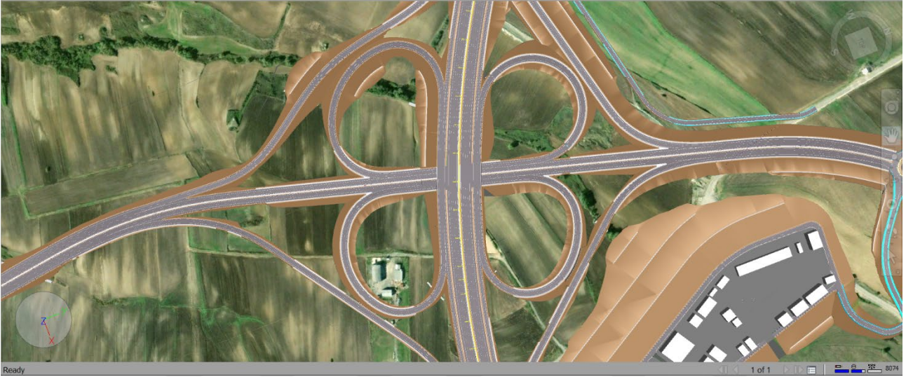
Şekil 4.30: Yonca kavşak modeli- plan.
