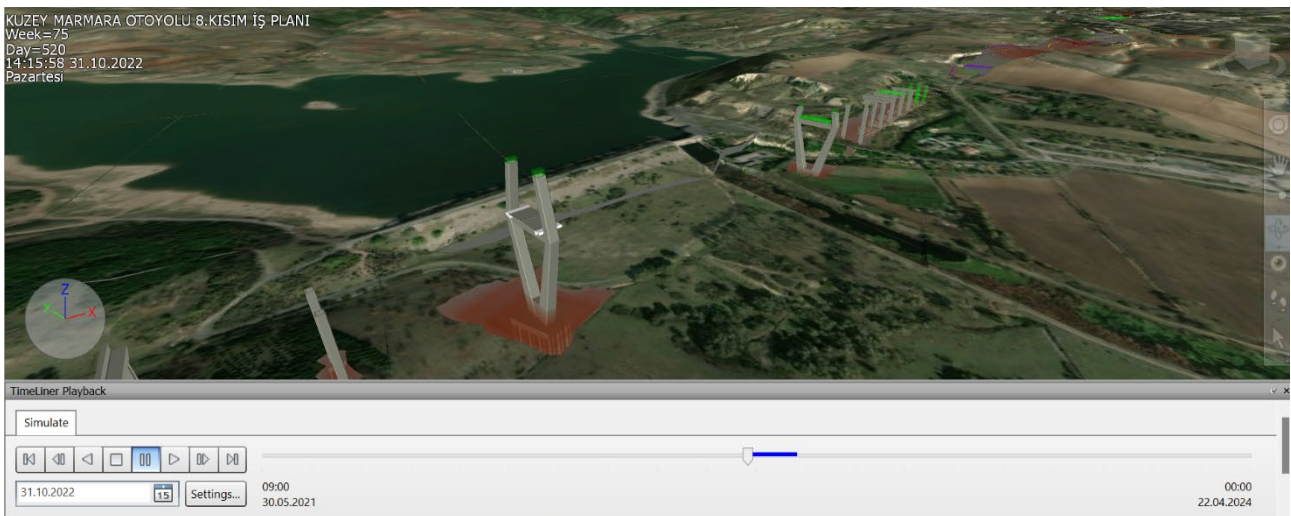
Şekil 4.37: Navisworks, EAK batı pilon ano-12 timeliner gösterimi.
