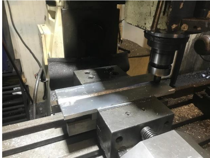
Şekil 5.2: Numunelere freze tezgahında kaynak ağızı açılması.
