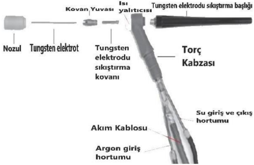
Şekil 3.4: TIG Kaynak torcu ve elemanları [22].
