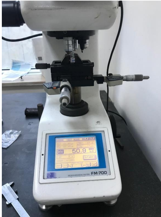
Şekil 5.13: Sertlik testlerinin yapıldığı mikro sertlik cihazı.
