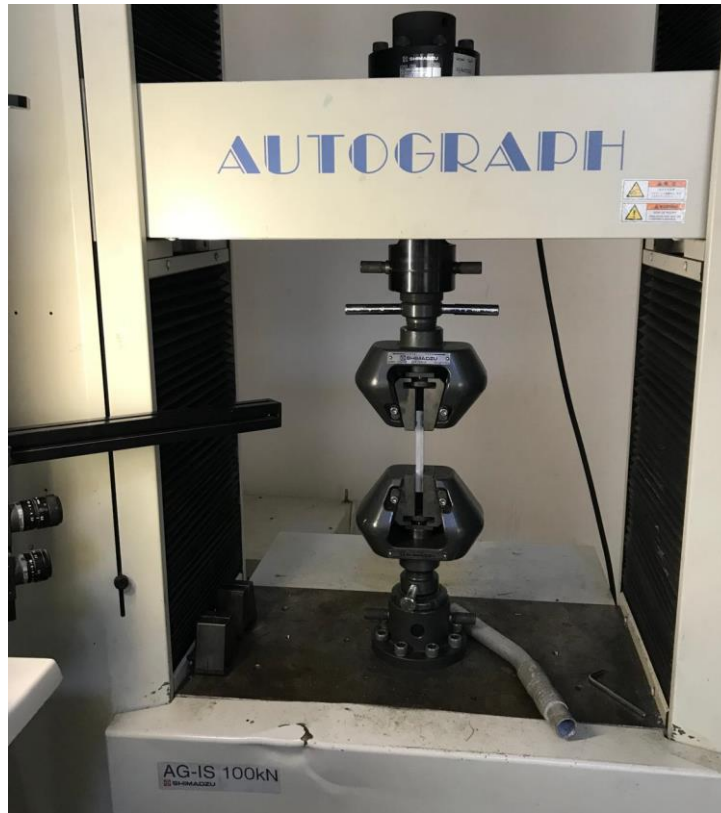
Şekil 5.14: Çekme testlerinin yapıldığı çekme cihazı.
