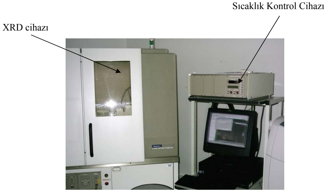
Şekil 3.4: XRD cihazı (Anadolu Üniversitesi Mühendislik Mimarlık Fakültesi Seramik Bölümü)
