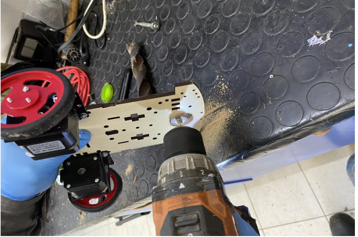
Şekil 4.5: Ahşap şase üzerine döner teker yuvası açılması.
