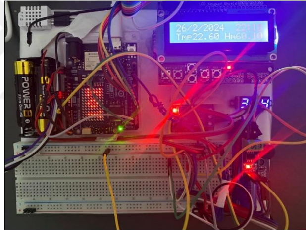
Şekil 5.19: Uygulama yapısı ana elektronik kontrol sistemi.
