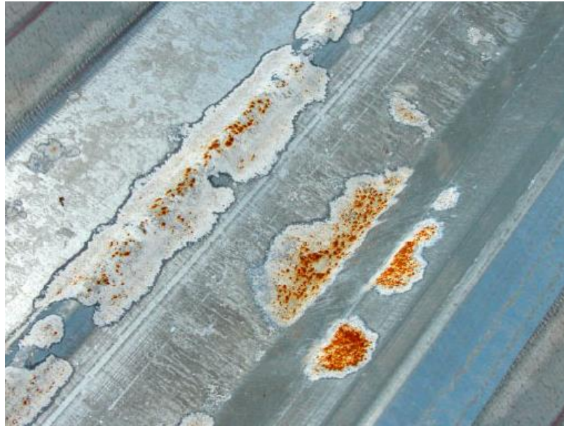
Şekil 6.13: Kırmızı pas oluşumu gözlemlenen galvanizli sac [36].
