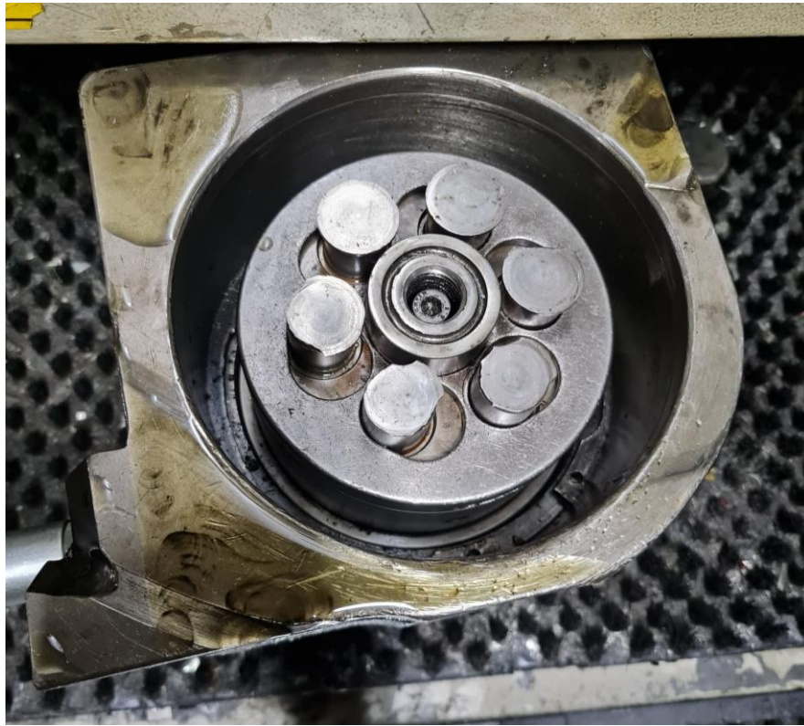
Şekil C.6: Punch kesim kafası içi.
