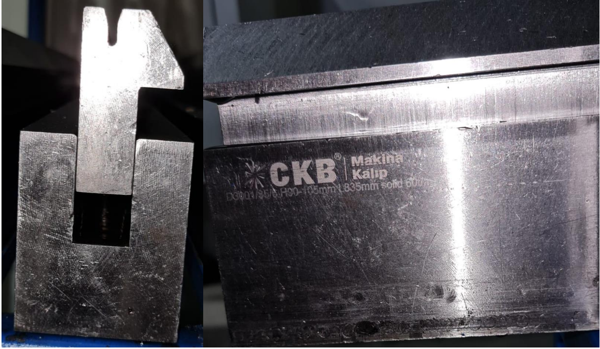
Şekil C.21: D3001/35/6 model abkant alt kalıbı.
