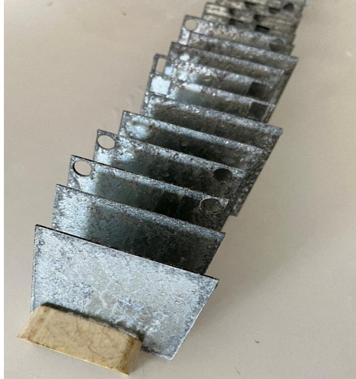
Şekil 7.33: Tuz sisi testi 48. saat pas oluşumu.
