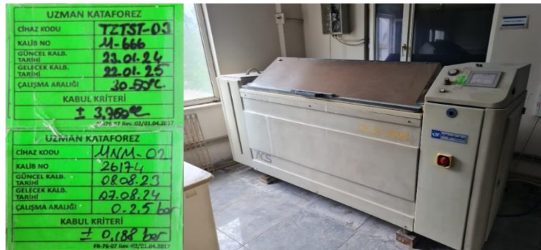
Şekil 7.31: Tuz sisi test cihazı ve kalibrasyon ayarlarının yapıldığı kabul şartları.
