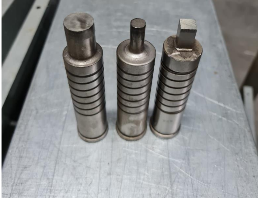
Şekil C.7: Numune hazırlanmasında seçilen punch kesme takımları.
