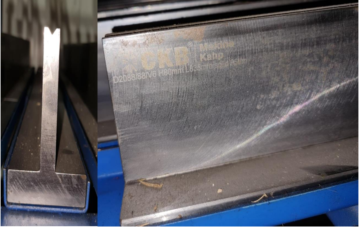
Şekil C.19: D2088/88/V6 model abkant alt kalıbı.
