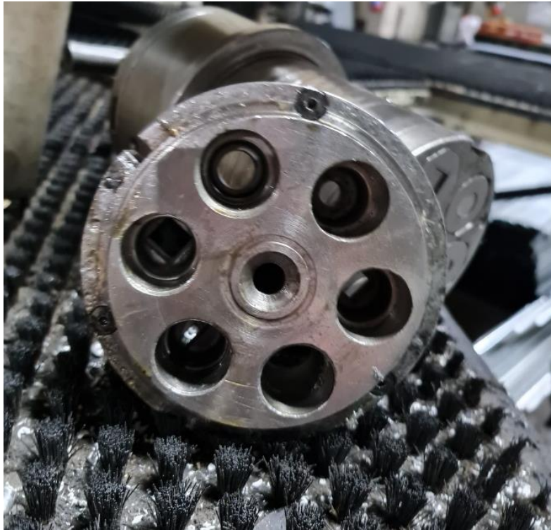
Şekil C.10: Tarete kesici takımların takıldığı kısım.
