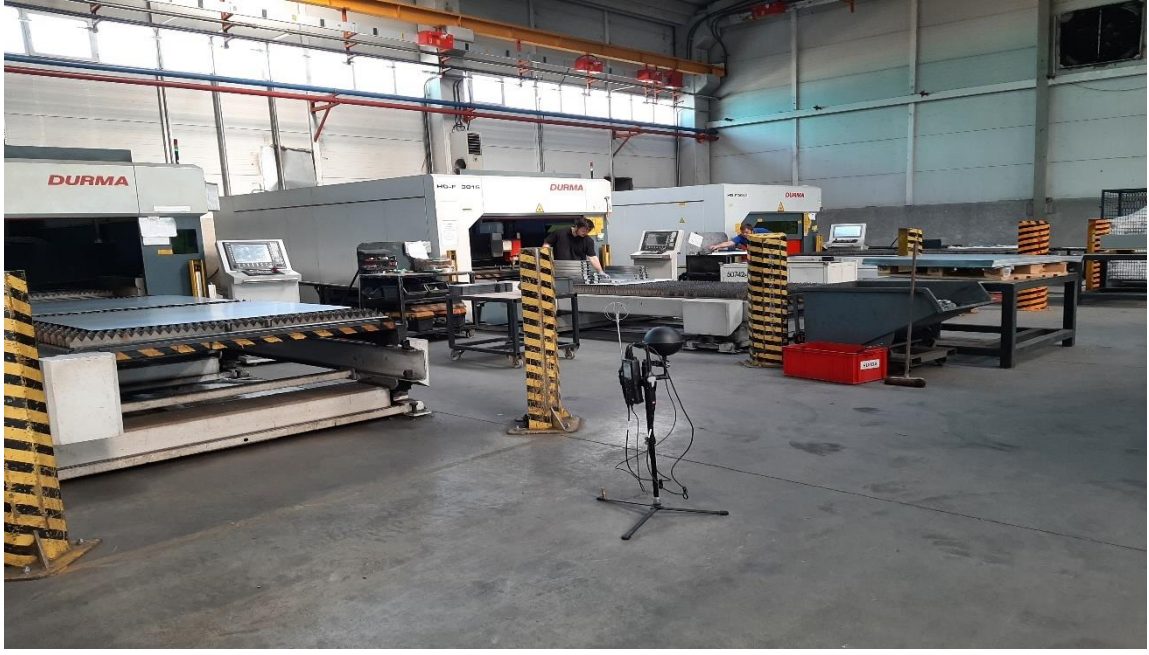
Şekil 2.11: Lazer kesim prosesi ve Testo 480 cihazı görüntüsü.
