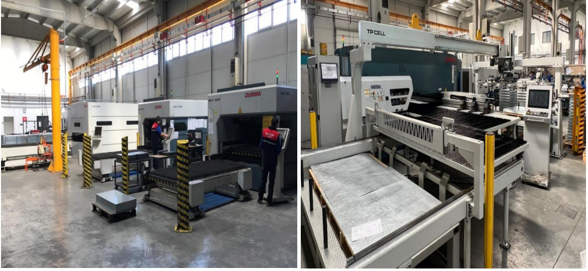
Şekil 2.6: Saha çalışması yapılan fabrikanın lazer kesim imalat prosesi.
