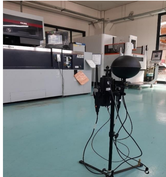
Şekil 2.10: Talaşlı imalat ve tel erzyon prosesi ile Testo 480 cihazı görüntüsü.
