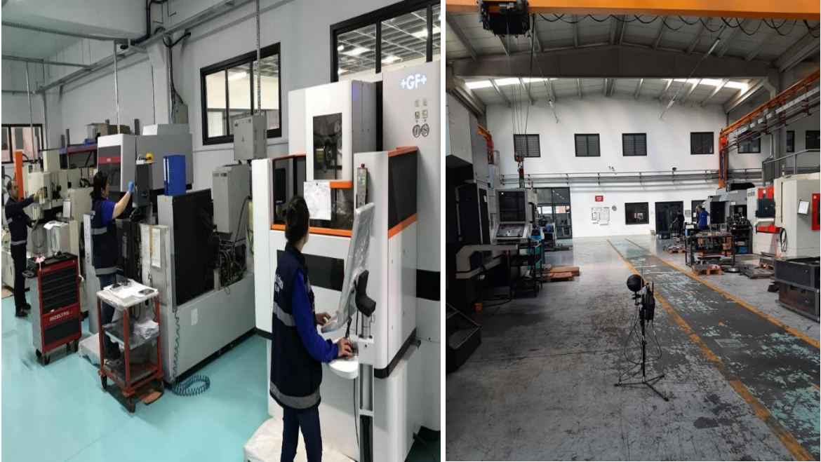
Şekil 2.5: Saha çalışması yapılan fabrikanın tel erezyon ve CNC işlem imalat prosesi.
