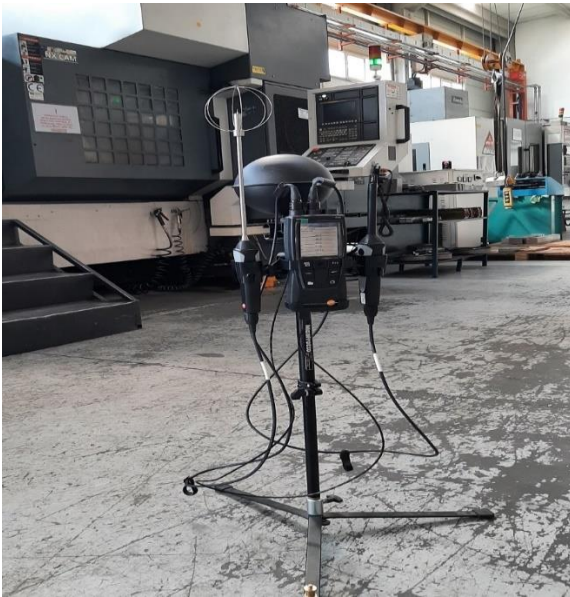
Şekil 2.10: Talaşlı imalat ve tel erzyon prosesi ile Testo 480 cihazı görüntüsü.
