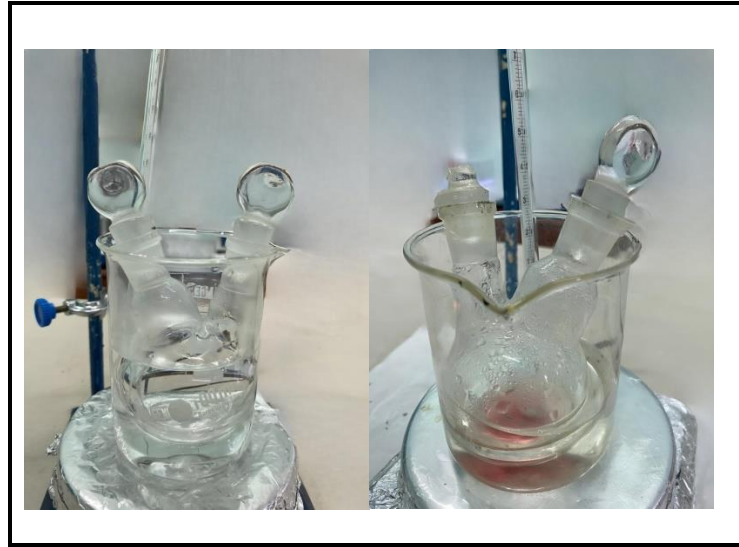
Şekil 2.3: Laboratuvarda Si NP sentezinde kullanılan reaksiyon düzeneği.
