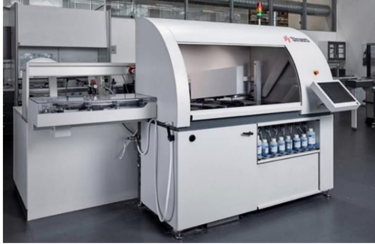
Şekil 5.11: Struers marka Hexamatic Robotik zımparalama ve parlatma cihazı [29].
