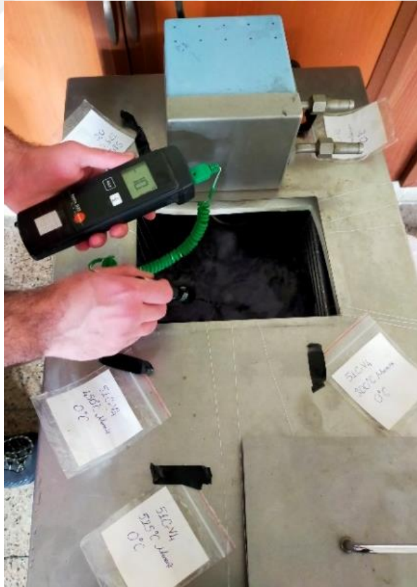
Şekil 5.19: Testo 925 daldırma tip termometre ile sıcaklık ölçümünün yapılması.
