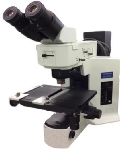
Şekil 5.12: OLYMPUS marka BX51M model metalurji mikroskobu [30].
