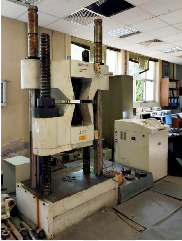
Şekil 5.15: SCHIMADZU marka UH - F1000kN model çekme test cihazı.
