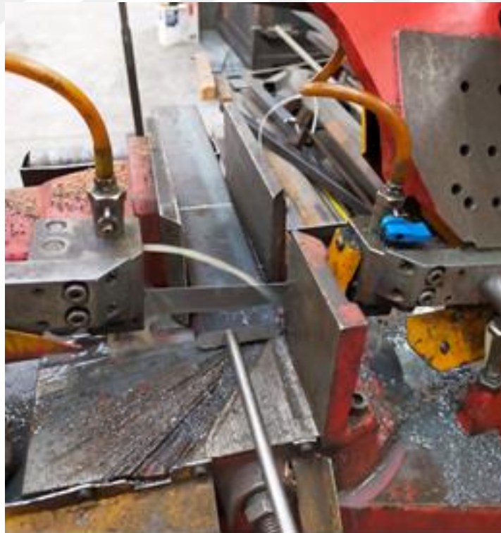
Şekil 5.3: Numunelerin hadde yönüne dik olarak kesilmesi.
