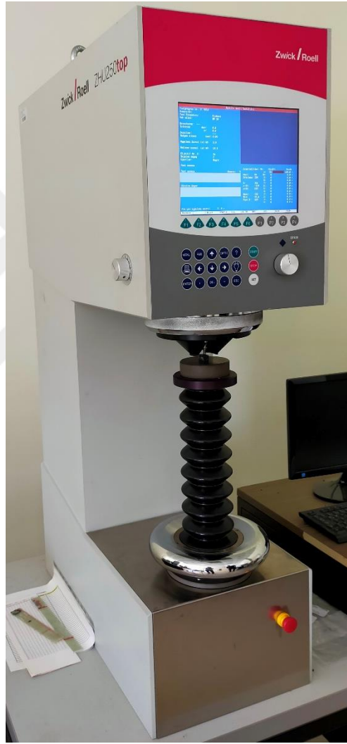
Şekil 5.13: Zwick/Roell marka ZHU250 model sertlik cihazı.
