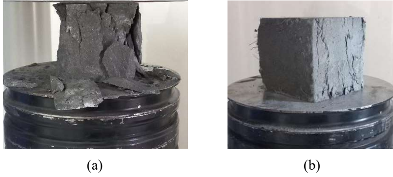
Şekil 3.2: Küp numunelerin kırılma şekilleri; a) Lifsiz, b) Lifli.
