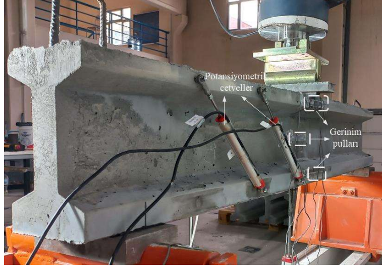
Şekil 2.14: Kirişin arka yüzüne yerleştirilen ölçerler.
