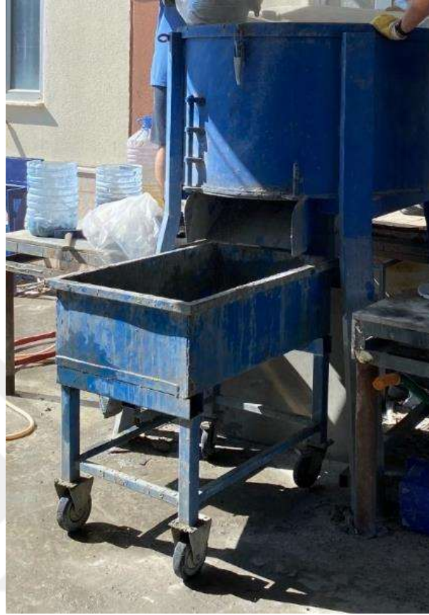
Şekil 2.5: Panmikser ve döküm aracı.
