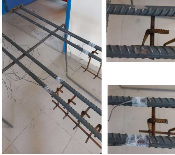
Şekil 2.15: Asal donatılara yerleştirilen ölçerler.
