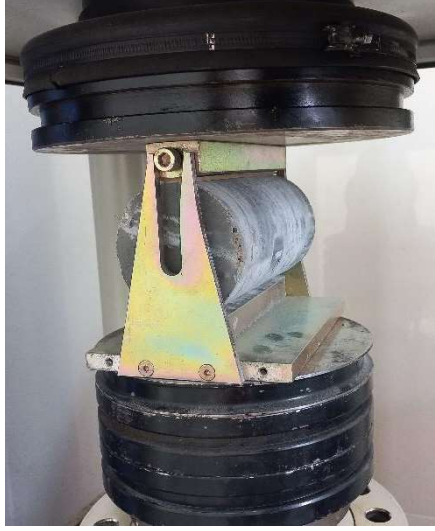
Şekil 2.11: Yarmada çekme test düzeneği.
