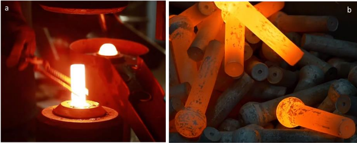
Şekil 4.6: a) Proses anı dış görünüş. b) Proses sonrası dövme hammadde.
