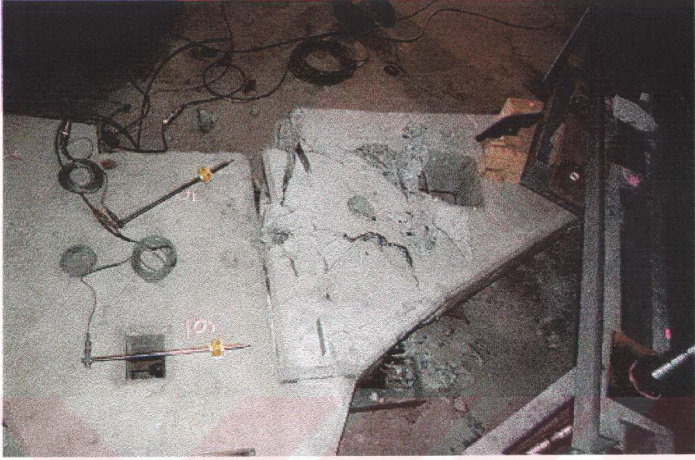
Şekil 4.7 Taşıma gücünü yitirmiş birleşim
