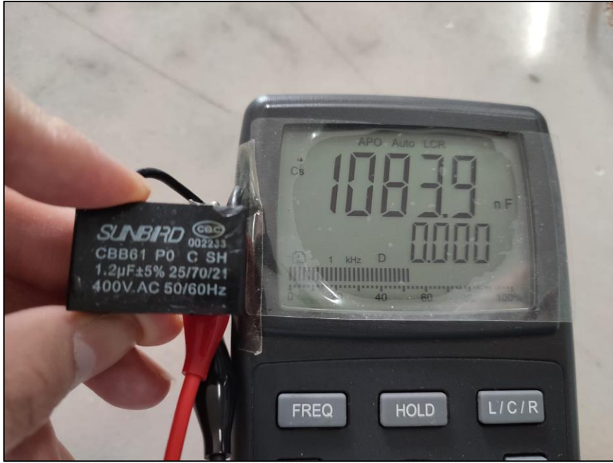
Şekil 3.15: Rezonans tankının kapasite ölçüm değeri.
