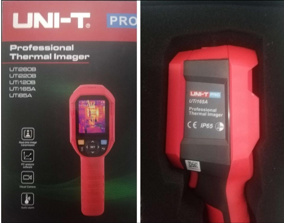
Şekil 3.23: Deney çalışmasında kullanılan termal kamera.
