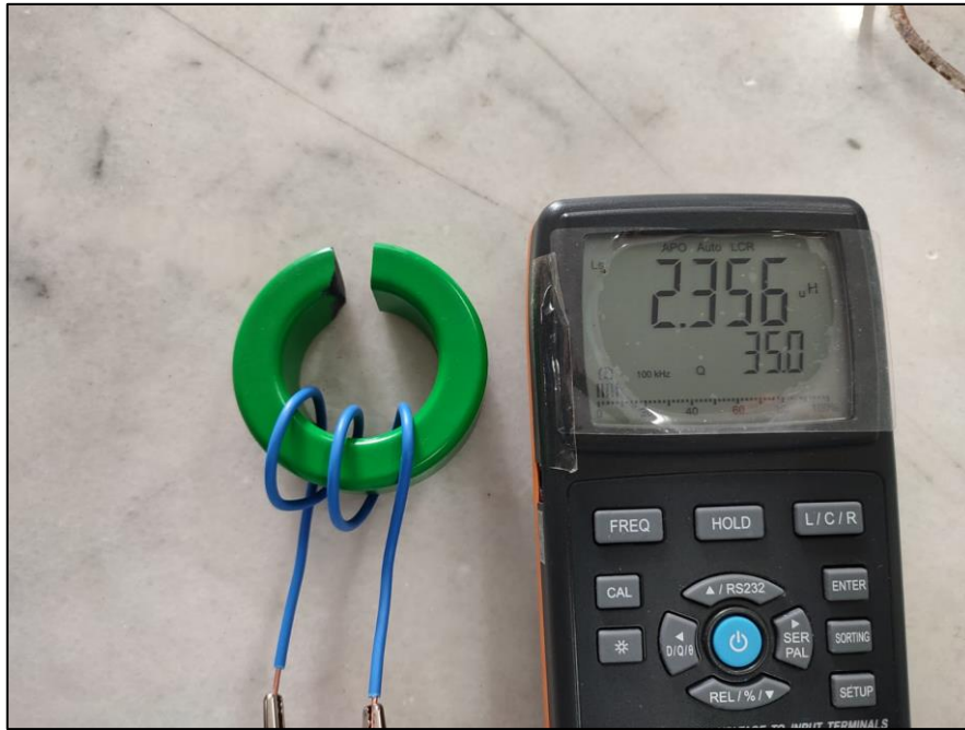
Şekil 3.16: Ferrit çekirdeğe sarılmış rezonans tankındaki bobinin endüktans değeri.
