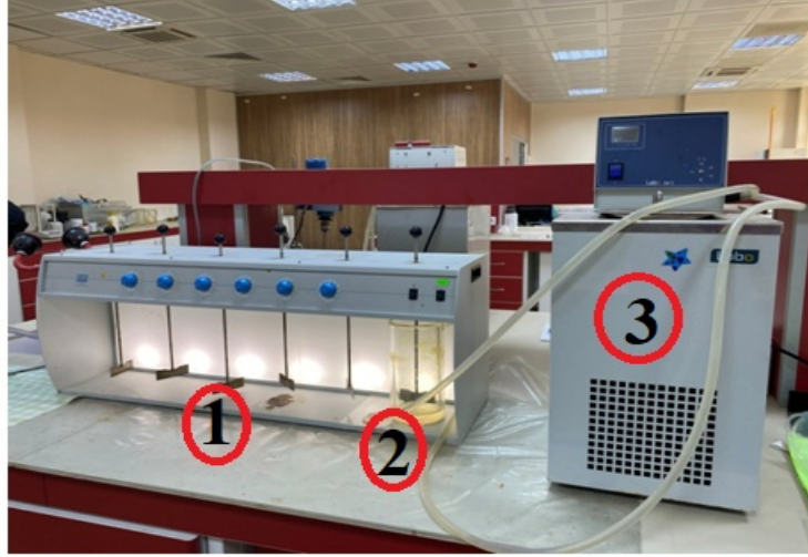
Şekil 3.3: Kalsiyum hidroksit, magnezyum hidroksit ve demir hidroksitle bor, sülfat ve arsenik arıtımının optimizasyonunda kullanılan jar testi cihazı (1:Jar testi cihazı, 2: Kesikli reaktör, 3: Isıtımlı-soğutmalı su sirkülatörü).
