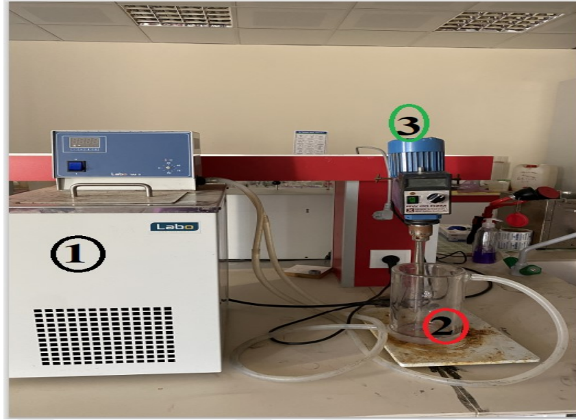
Şekil 3.1: Kalsiyum hidroksit, magnezyum hidroksit ve demir hidroksit ile bor arıtımında kullanılan kesikli reaktör deneysel sistemi (1: Isıtma-soğutma kontrollü su sirkülatörü, 2: Kesikli reaktör, 3: Dijital mekanik karıştırıcı).
