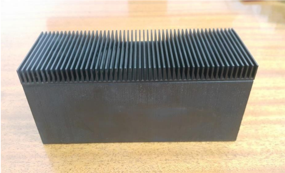
Şekil 3.4: 1 mm kalınlık 10 mm yükseklik ve 2 mm aralığa sahip alüminyum kanatçıklar (1.batarya modeli).
