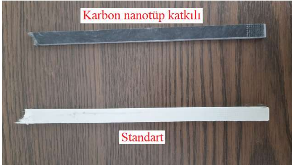
Şekil 2. Ölçümlerde kullanılan standart ve karbon nanotüp katkıli numuneler.
