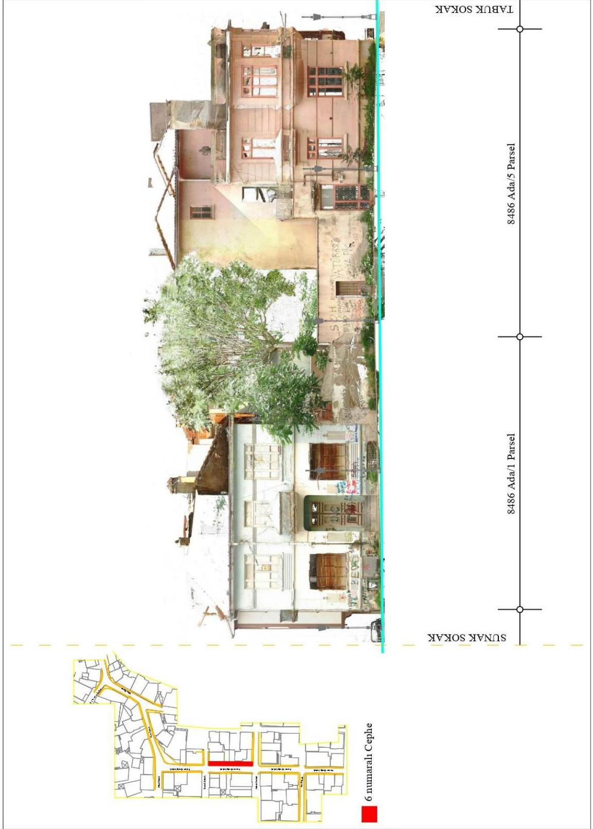
Şekil 5.21: 6 numaralı cephe sağıklaştırma öneri projeleri-ölçek:1/200.
