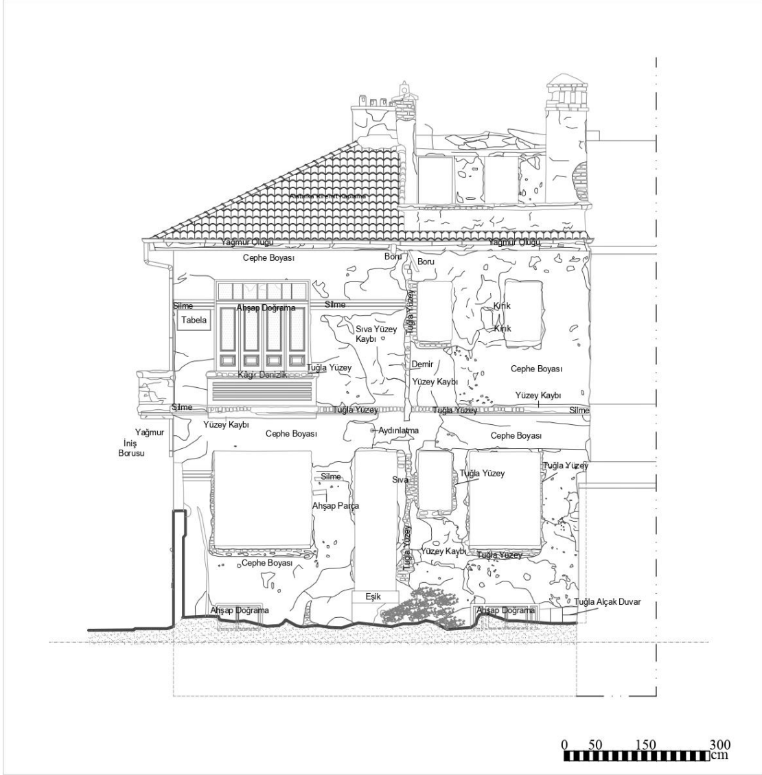
Şekil 6.274: 14 numaralı yapı sağ yan cephe.
