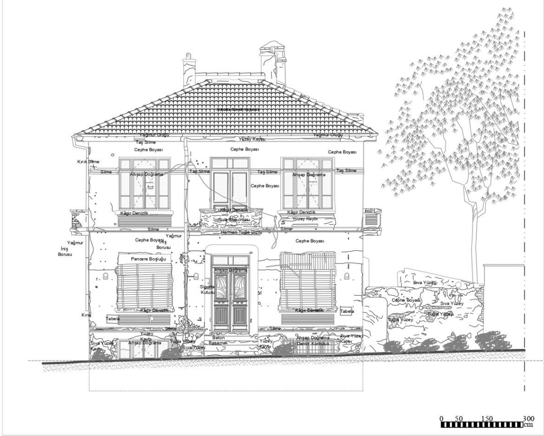
Şekil 6.273: 14 numaralı yapı ön cephe.
