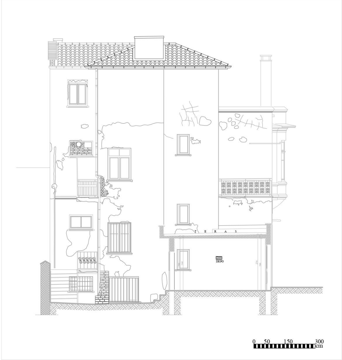
Şekil 6.208: 10 numaralı yapı sol yan cephe.
