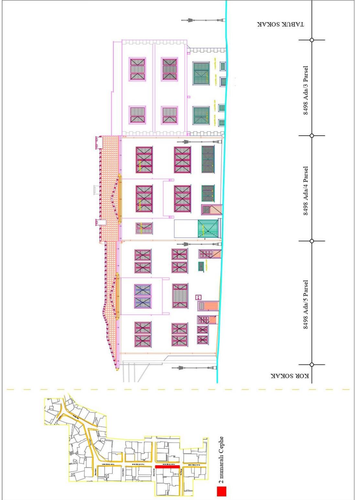
Şekil 5.17: 2 numaralı cephe sağıklaştırma öneri projeleri-ölçek:1/200.
