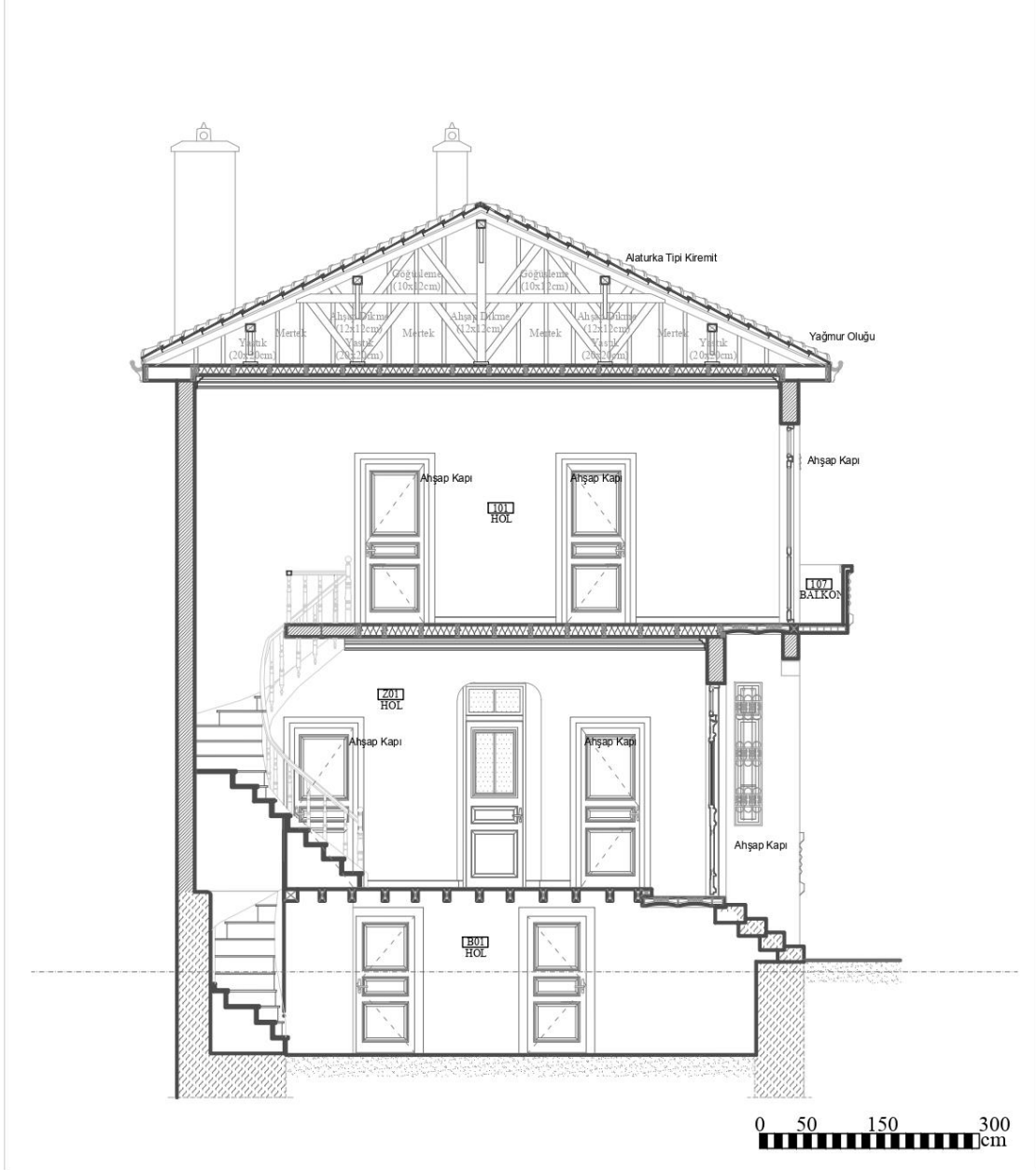
Şekil 6.297: 14 numaralı yapı 3-3 kesiti.
