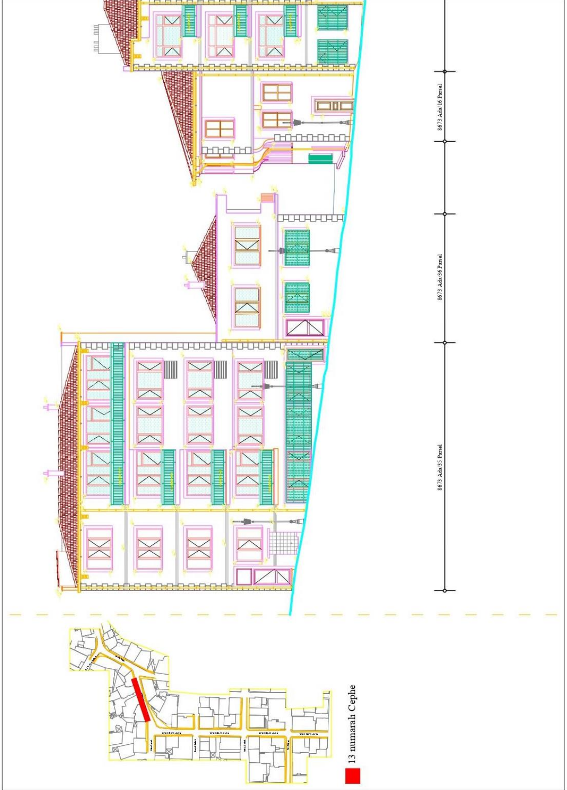
Şekil 5.28: 13 numaralı cephe sağıklaştırma öneri projeleri-ölçek:1/200.
