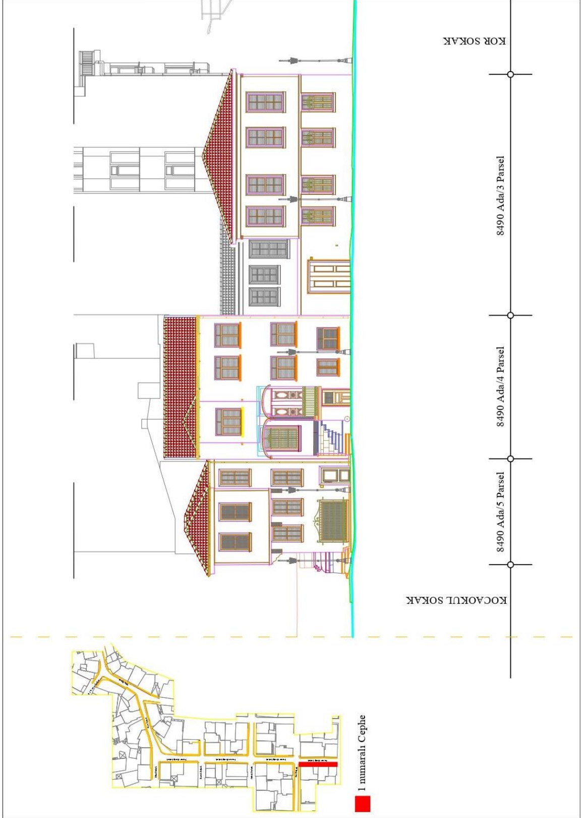
Şekil 5.16: 1 numaralı cephe sağliĸlařtırma öneri projeleri-ölçek:1/200.
