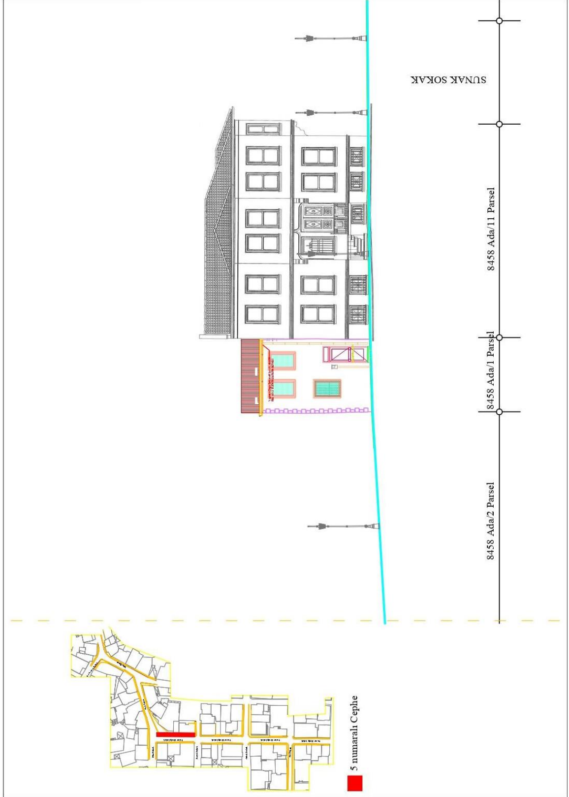
Şekil 5.20: 5 numaralı cephe sağıklaştırma öneri projeleri-ölçek:1/200.
