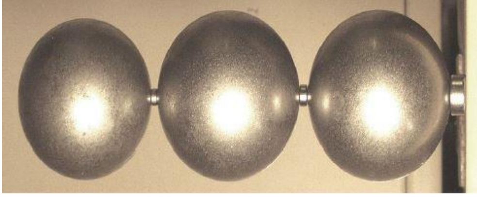
Şekil 1.25: Çelik silindirleri tutan, neodmiyum mıknatısları
