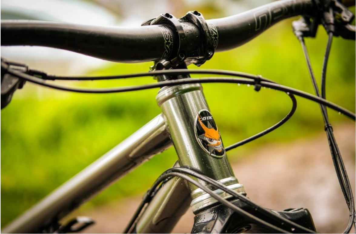
Şekil 1.2: Skandiyum çerçeve kullanılan bir dağ bisikleti ( https://off.road.cc/content/feature/the-ultimate-guide-to-frame-materials-whats-best-for-bikes-664 )
