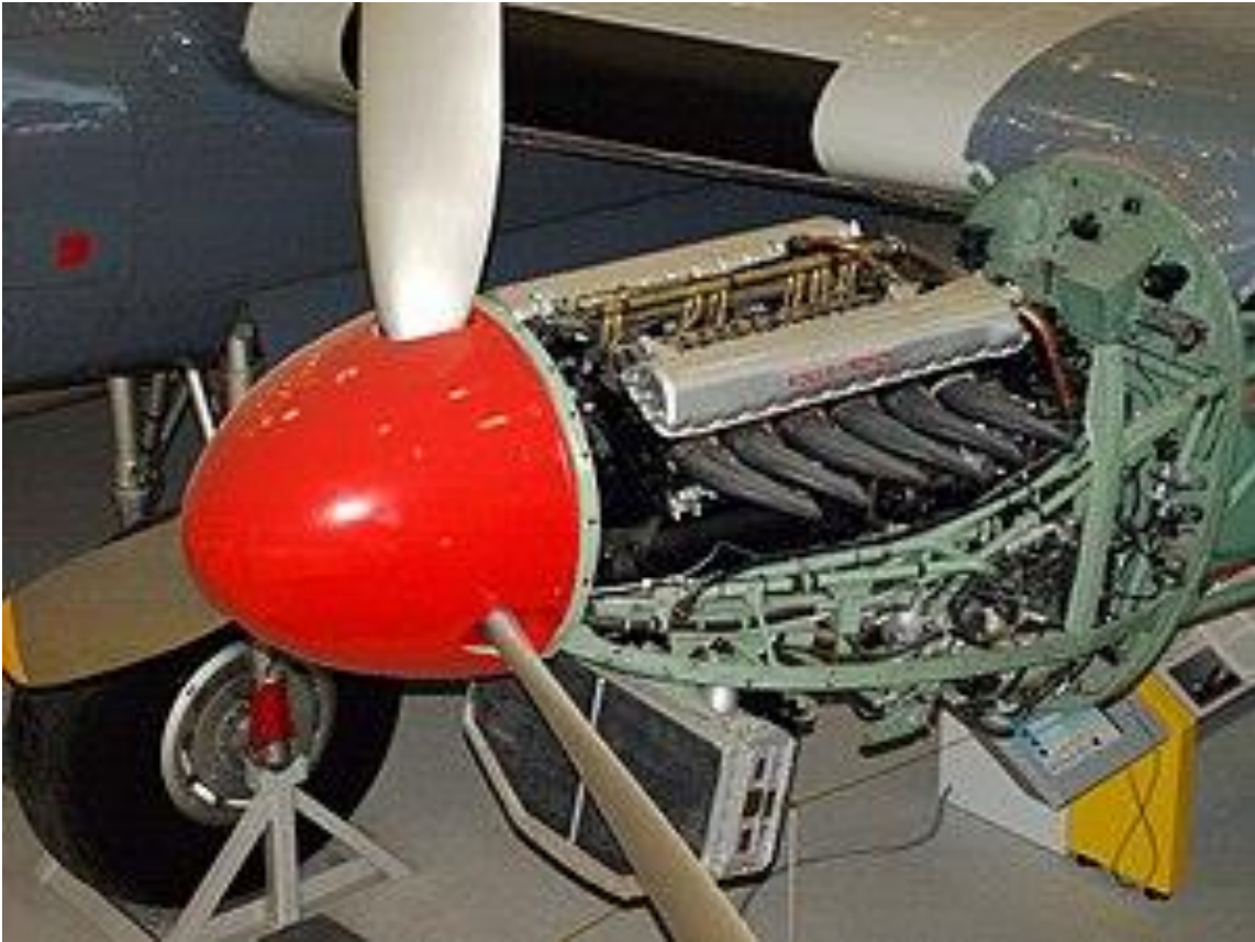
Şekil 1.19: Avro York'a monte edilmiş bir Rolls-RoyceMerlin motoru. ( https://en.wikipedia.org/wiki/Aircraft_engine )
