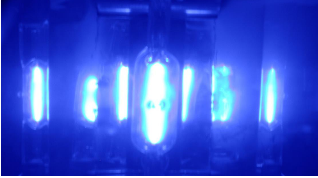
Şekil 1.23: Yüksek basınçlı ultraviyole bronzlaşma ünitesi lambası ( https://en.wikipedia.org/wiki/Tanning_lamp#/media/File:Ultraviolet_tanning_bed_lamp_running.JPG )
