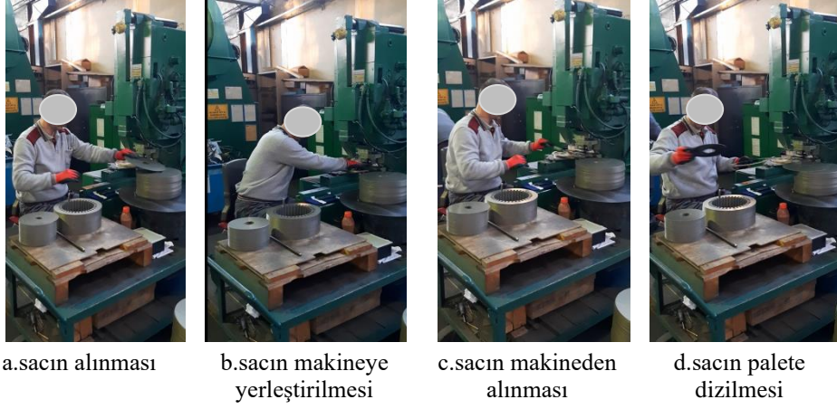
Şekil 2. Stator sac kesim işlem süreci.
