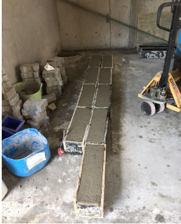
Şekil 3.28: 150x150x550 mm kiriş numuneleri.
