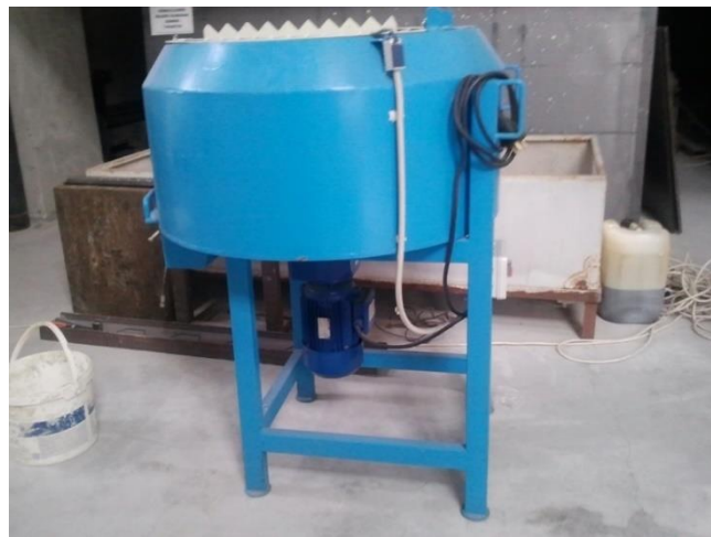
Şekil 3.3: Beton karışımında kullanılan laboratuvar tipi beton mikseri.
