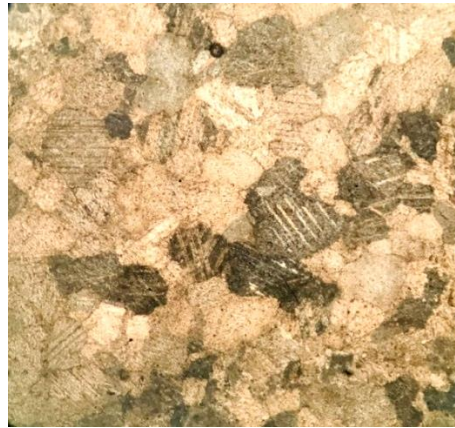
Şekil 4.1: Çalışma sahası mermerlerinde granoblastik doku gösteren kalsit minerallerinin görünümü (4X; Ç.N.).
