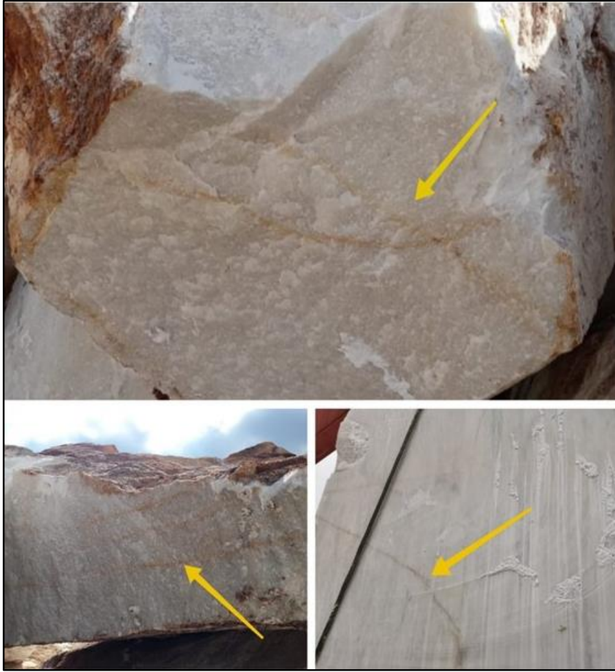
Şekil 3.10: Başalan mermerlerindeki ve bölgedeki açık maden sahalarındaki blok hacmini etkileyen oldukça kırılğan sarı damarların görünümü.
