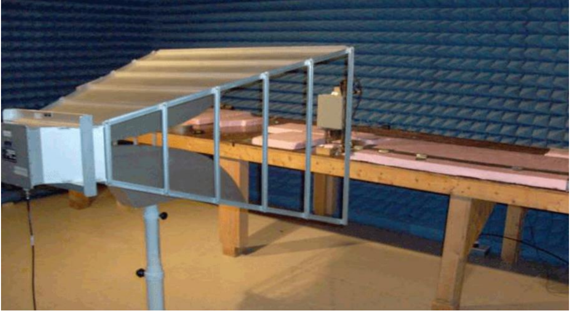
Şekil 4.19: Işıma yolu ile emisyon test düzeneği örneği (horn anten).
