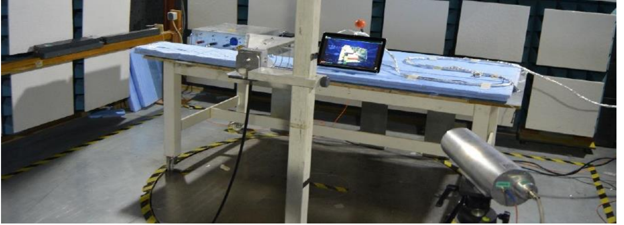
Őekil 5.4: Iřımaya yolu ile bağışıklık test düzeneđi örneđi.
