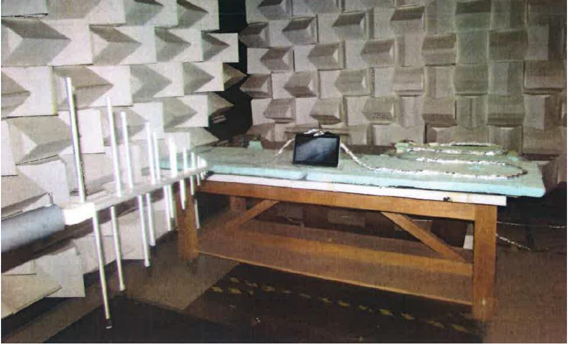
Şekil 5.6: Yatay polarizasyonda ışıma yolu ile emisyon test düzeneği örneği.
