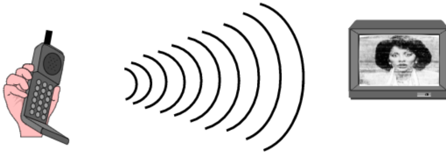
Şekil 2.7: Işıma yoluyla elektromanyetik girişime örnek.
