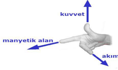
Şekil 2.4: Sağ el kuralı ile manyetik alan vektör yönlerinin belirlenmesi.
