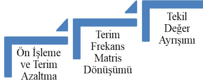
Şekil 2. Gizli anlam analizi işlem adımları.
