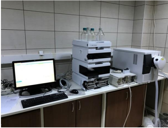
Şekil 3.6. UYA örneklerinin analiz edildiği HPLC cihazı (BÜBTAM, Balıkesir).
