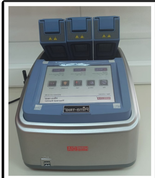
Şekil 3.1. Viral etkenlerin PCR analizleri için kullanılan termal çevirici cihaz.
