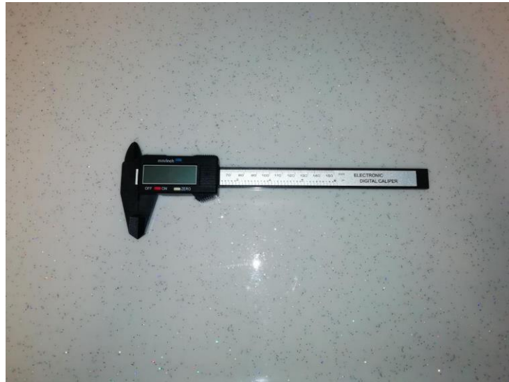
Şekil 3.2. RID halka çaplarının analizlerinin yapıldığı elektronik dijital çapölçer
