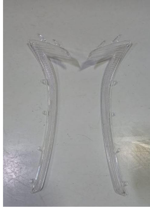
Şekil 4.3: Sağ ve sol lens tırnak hatalı parça görünümü.
