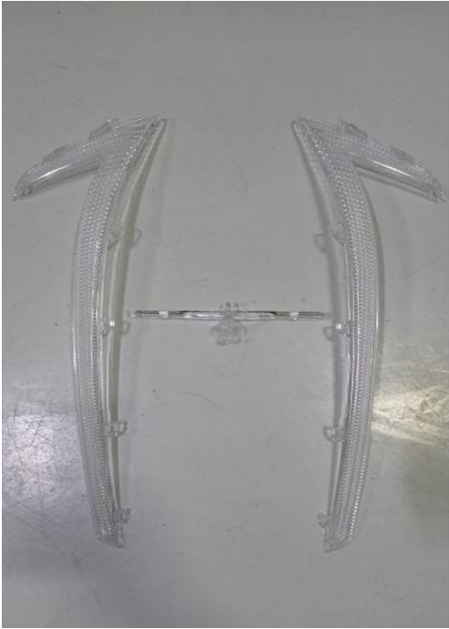
Şekil 4.3: Sağ ve sol lens tırnak hatalı parça görünümü.
