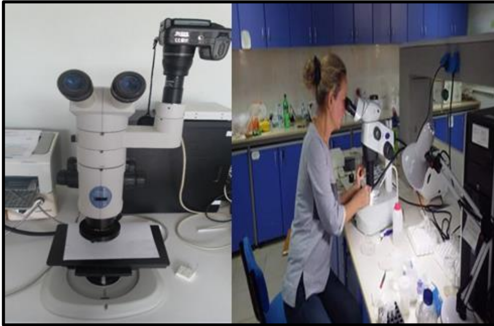
Şekil 4.7: Laboratuvarda ayrılan örneklerin üst taksonlara göre gruplandırılması ve tür tanılamada kullanılan Nikon marka SMZ 1500 model ve Olympus marka SZX10 model stereo mikroskop.
