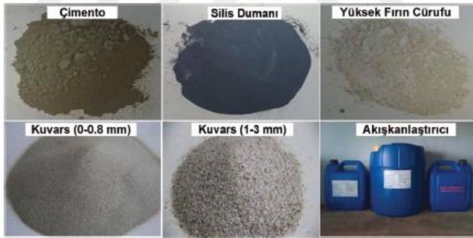
Şekil 4.3: UYPLB üretiminde kullanılan bileşenler.
