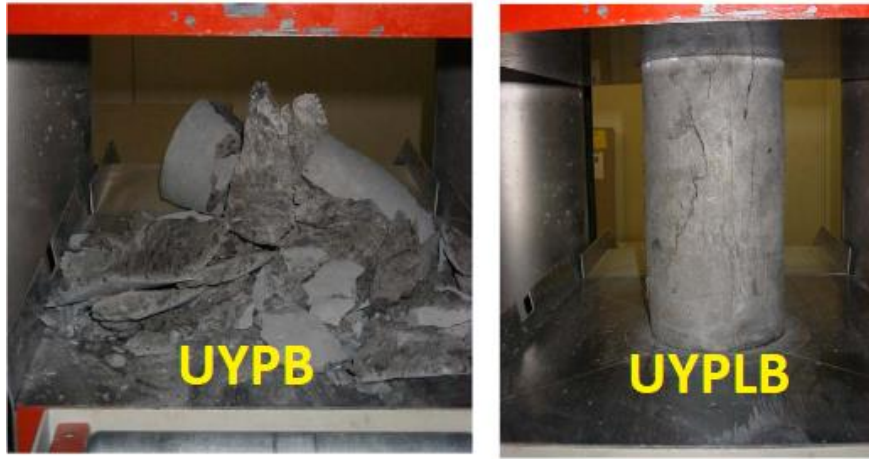
Şekil 3.4: Soldaki şekilde lif takviyesiz UYPB'nin, sağdaki şekilde ise UYPLB'nin aynı gerilme altındaki davranışı gösterilmektedir (Fehling ve diğ., 2005).
