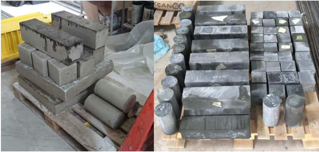
Şekil 4.10: Mekanik özelliklerin belirlenmesi için üretilen deney numuneleri.
