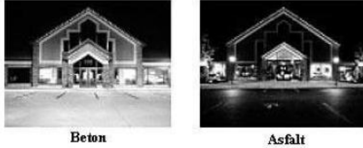
Şekil 2.12: Beton ve asfalt kaplamalı yolların gece görünüşleri (THBB, 2002).
