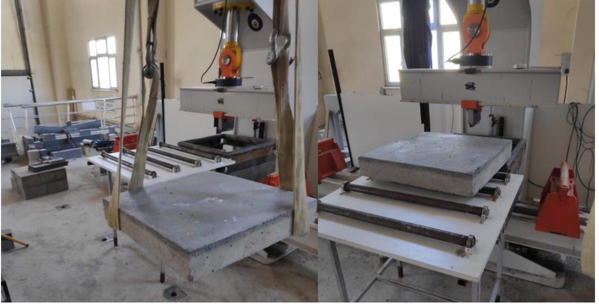
Şekil 4.62: Numunenin test düzeneğine yerleştirilmesi.
