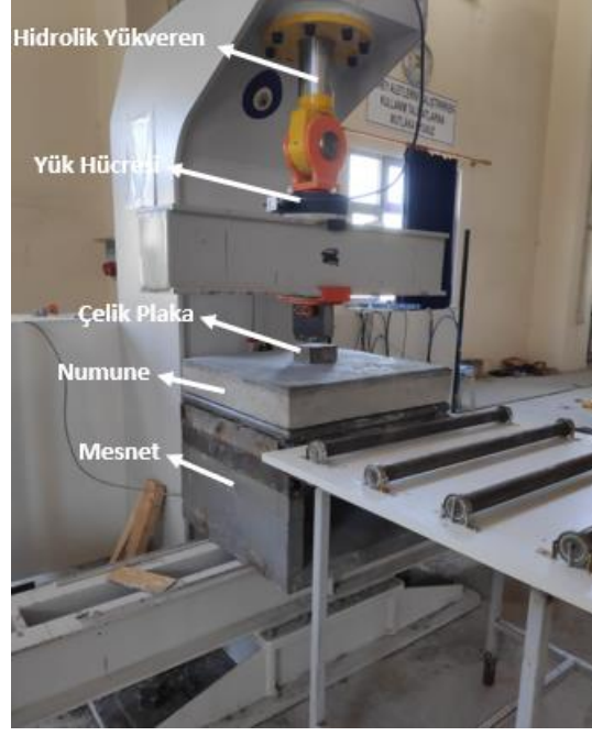
Şekil 4.61: Plaka eğilme testlerinin gerçekleştirildiği deney düzeneği.
