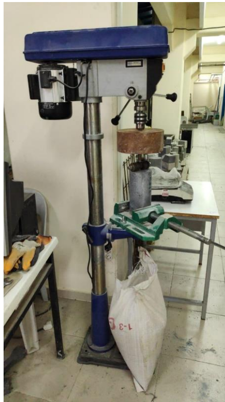
Şekil 4.31: ASTM C 944-99'a uygun aşınma deneyi ekipmanı.
