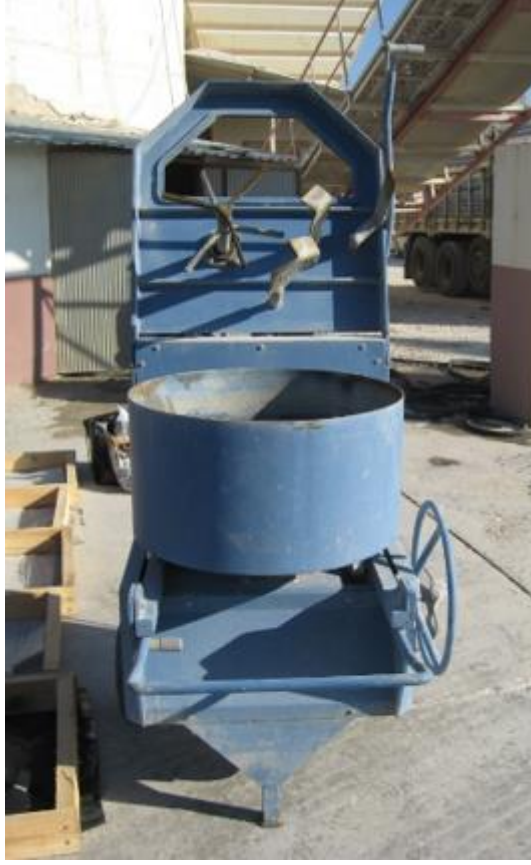
Şekil 4.4: Beton karıştırılma işinde kullanılan mikser.
