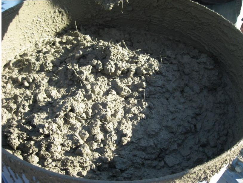
Şekil 4.5: Çelik lifli geleneksel beton karışımı.
