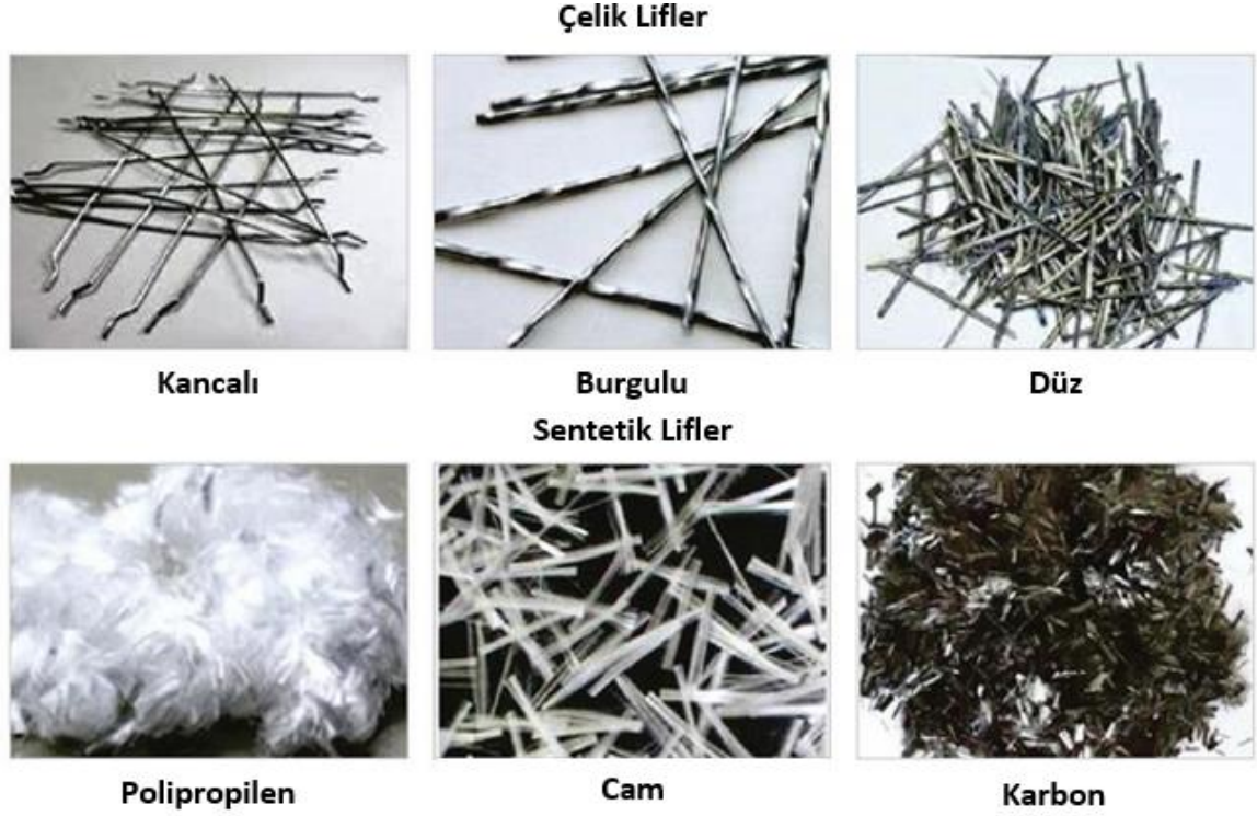
Şekil 3.3: Ultra yüksek performanslı lifli betonda kullanılan lif çeşitleri (Buttignol ve diğ., 2017).
