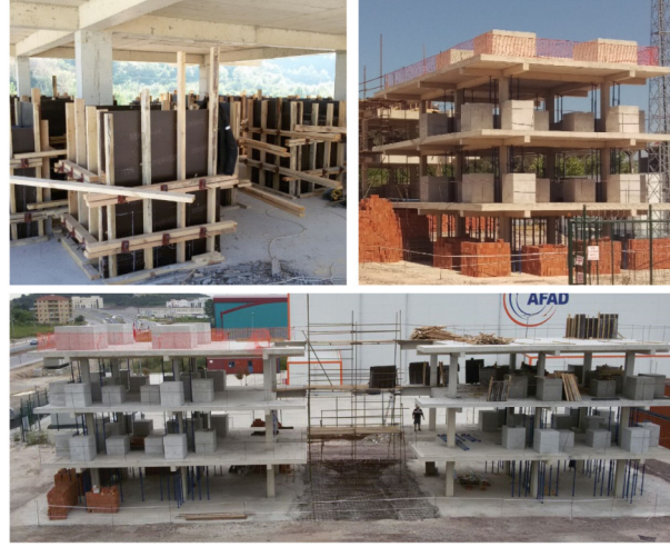
Şekil 3.17: Beton ağırlık bloklarının üretimi ve test binalarında görünüşleri.
