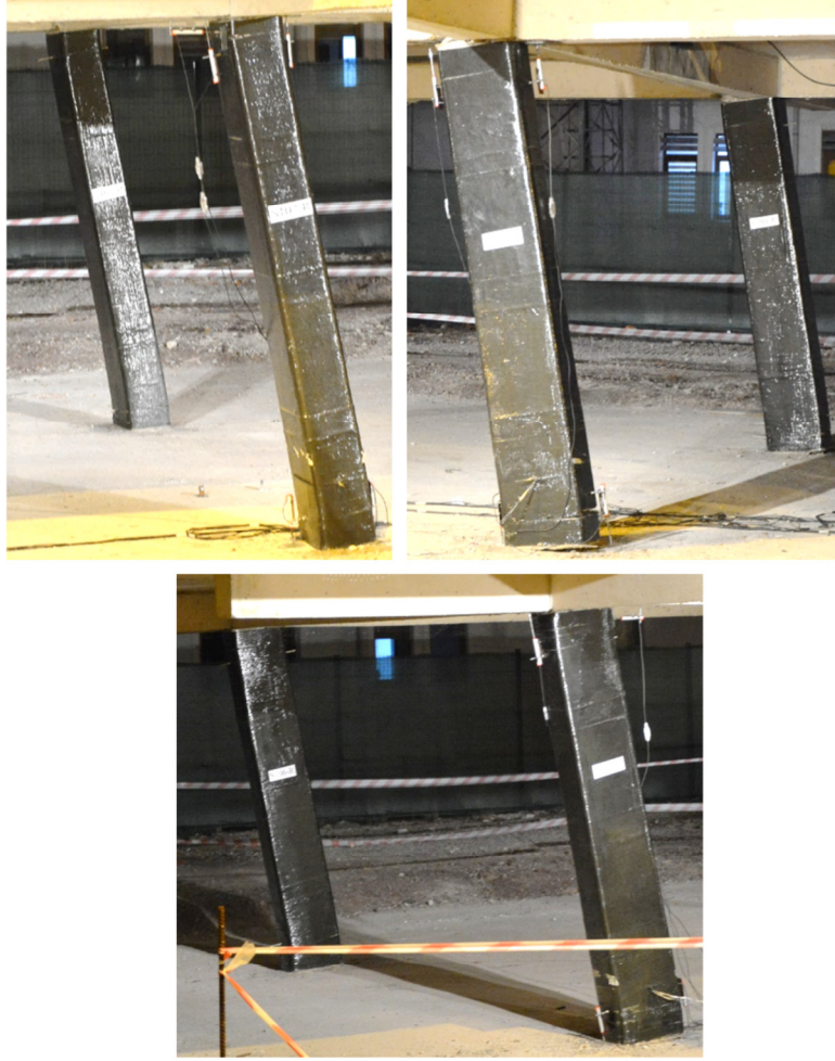
Şekil 3.52: LP ile sargılanmış kolonların deney sonu görünüşleri.
