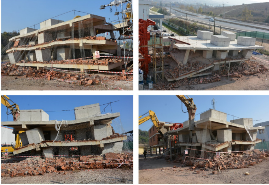
Şekil 3.43: Güçlendirilmemiş binanın test sonu görünümü.
