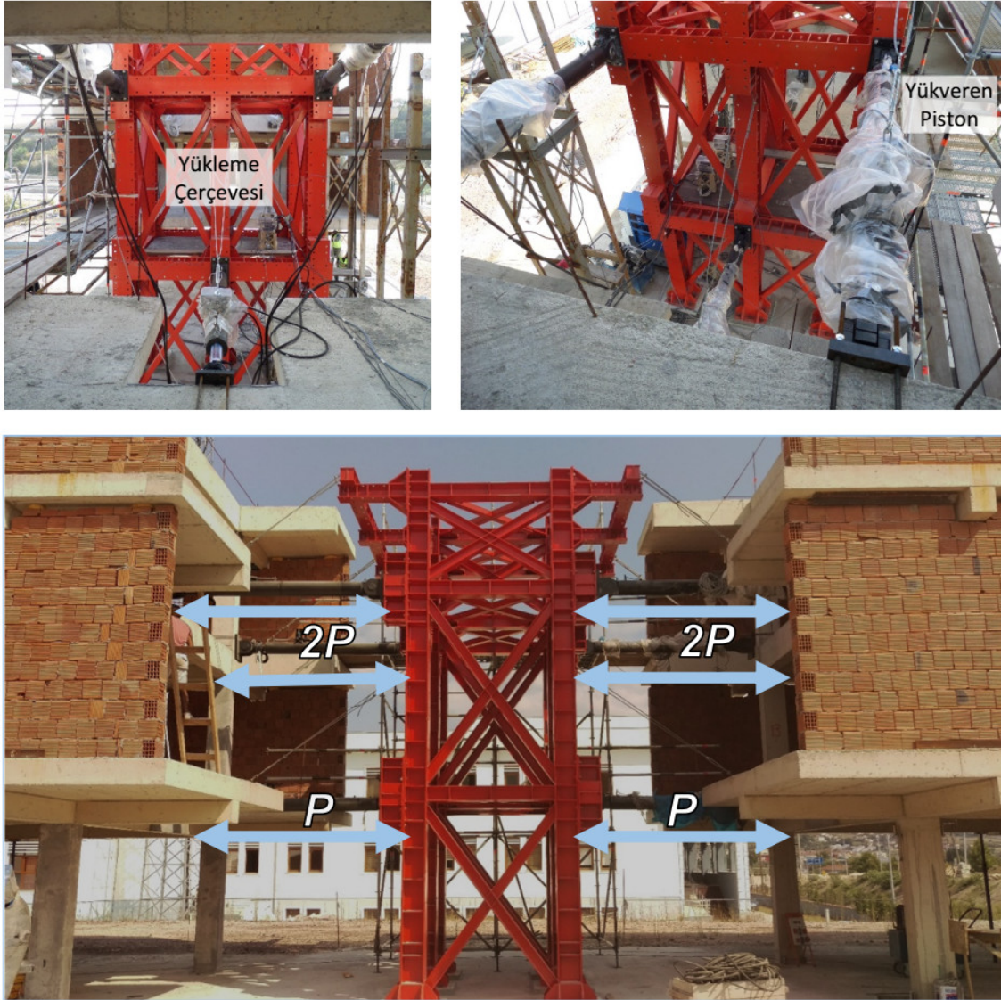
Şekil 3.30: Yükleme çerçevesi ve yükveren pistonların test binalarına göre konumu.
