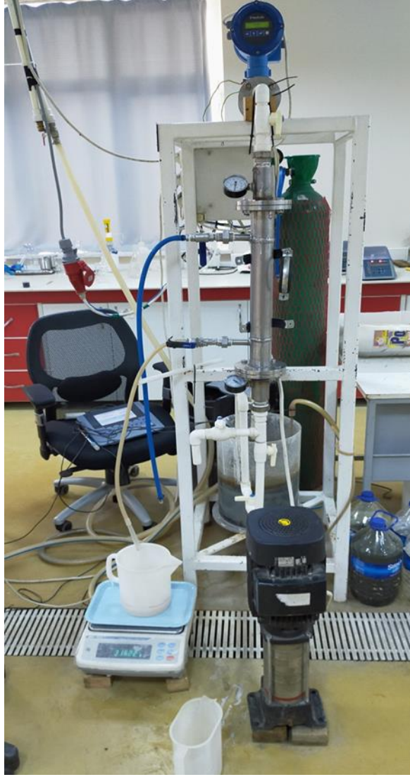
Şekil 3.2: Deneylerde kullanılan çapraz akışlı membran sistemi
