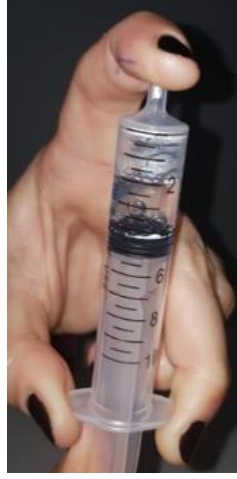
Şekil 3.39: 10ml'lik şırıngada suyun kaynaması
