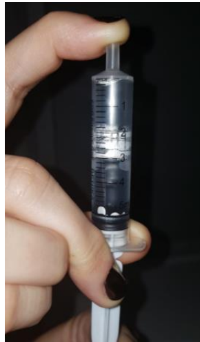
Şekil 3.38: 5ml'lik şırıngada suyun kaynaması
