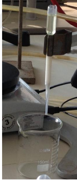
Şekil 2.1: Stiren monomerinden inhibitörün uzaklaştırılması sonrası alümina ile saflaştırılması.
