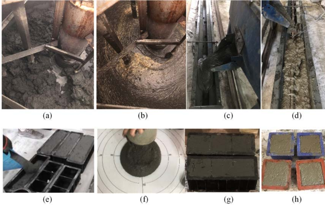
Şekil 2. Betonların hazırlanması (a) UYPLB karışımının topaklanma aşaması (b) UYPLB üretiminde lif ilavesi aşaması (c) ULPLB döküm aşaması (d) GB döküm aşaması (e) UYPLB prizma numuneleri (f) ULPLB kıvam testi (g) UYPLB küp numuneleri (h) GB küp numuneleri
