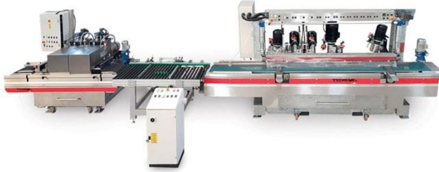
Şekil 1.9: Kesme ve profil oluşturma hattı [7].
