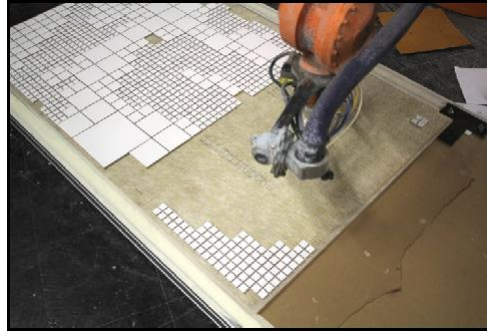
Şekil 2.6: ABB 4400 robotu, seramik karolar ile Marilyn Monroe'nun mozağini dizerken [15].
