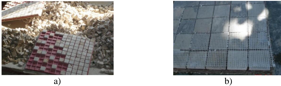
Şekil 1.8: a) Kalıplara dizilen karolar. b) Fileye yapıştırılmış karolar [6].
