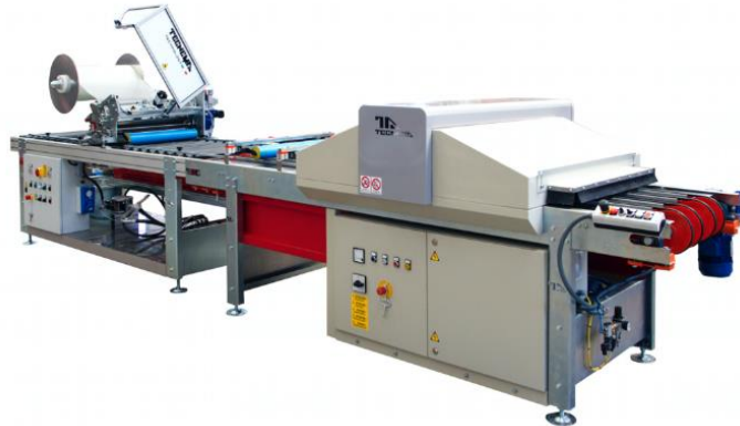
Şekil 1.10: Karo yapıştırma ve kurutma makinesi [7].
