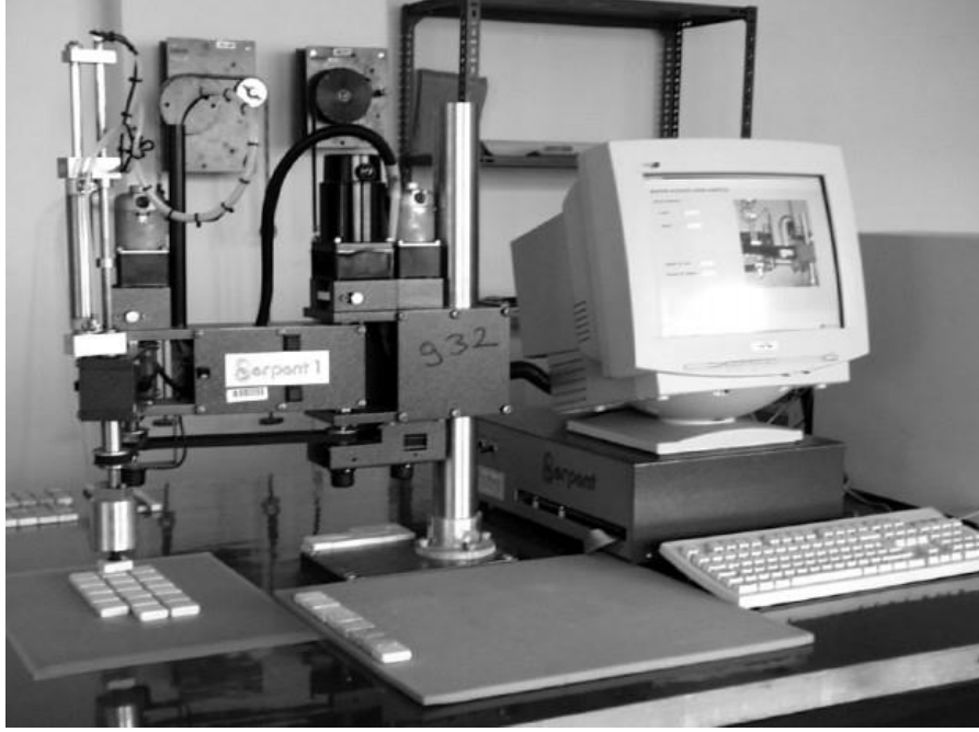
Şekil 2.2: Scara robot ile mozaik dizgi otomasyonu [9].
