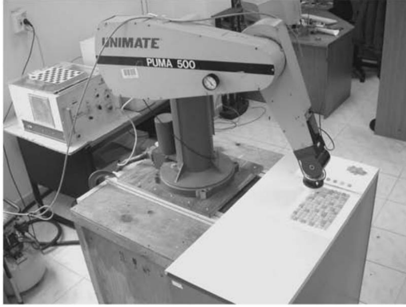
Şekil 2.3: Ultimate Puma 500 robot cam mozaik dizerken [10].
