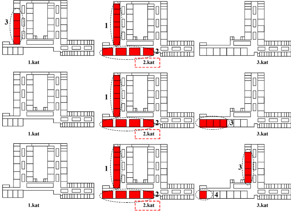
Şekil D.2: İkinci dönem derslik yerleşimi yapıldığında güneşin etkisine bağlı olarak sabaha yönelik geliştirilen 2GS6, 2GS7 ve 2GS8 senaryolarına ait derslik yerleşimleri.
