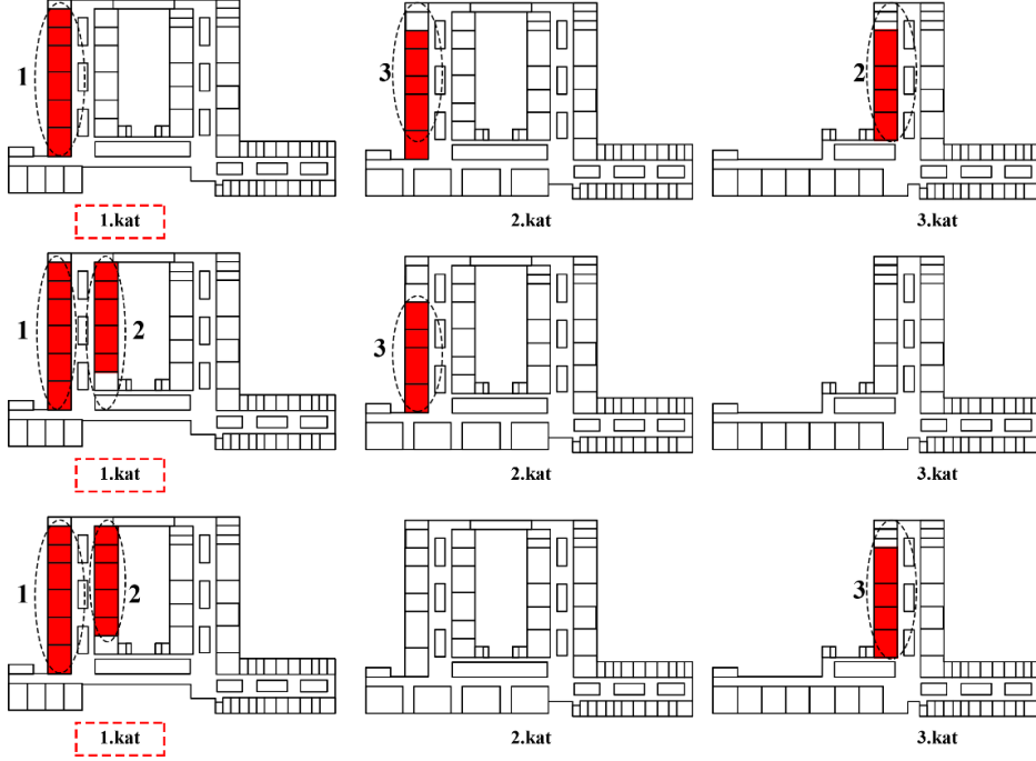
Şekil E.1: İkinci dönem derslik yerleşimi yapıldığında güneşin etkisine bağlı olarak öğleden sonraya yönelik geliştirilen 2GÖ2, 2GÖ3 ve 2GÖ4 senaryolarına ait derslik yerleşimleri.
