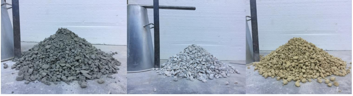
Şekil 3.39: Karışık (0-14 mm) malzemelerin duruş açısı.
