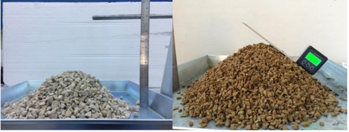
Şekil 3.7: Kumtaşı 10 – 14 mm pürüzsüz zeminde şişlenmemiş haldeki duruş açısı.
