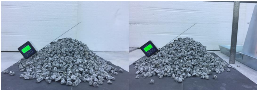
Şekil 3.6: Granit 10 – 14 mm pürüzlü zeminde şişlenmemiş haldeki duruş açısı.
