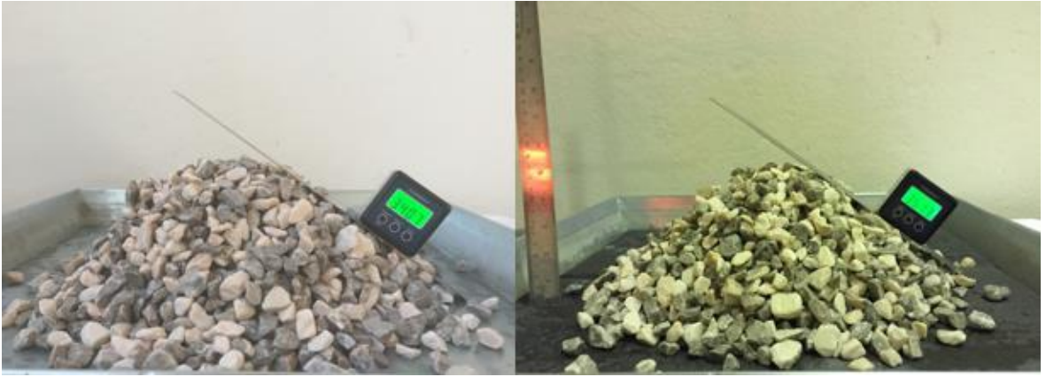
Şekil 3.8: Kireçtaşı 10 – 14 mm şişlenmemiş, kuru ve suya doymun haldeki duruş açısı.
