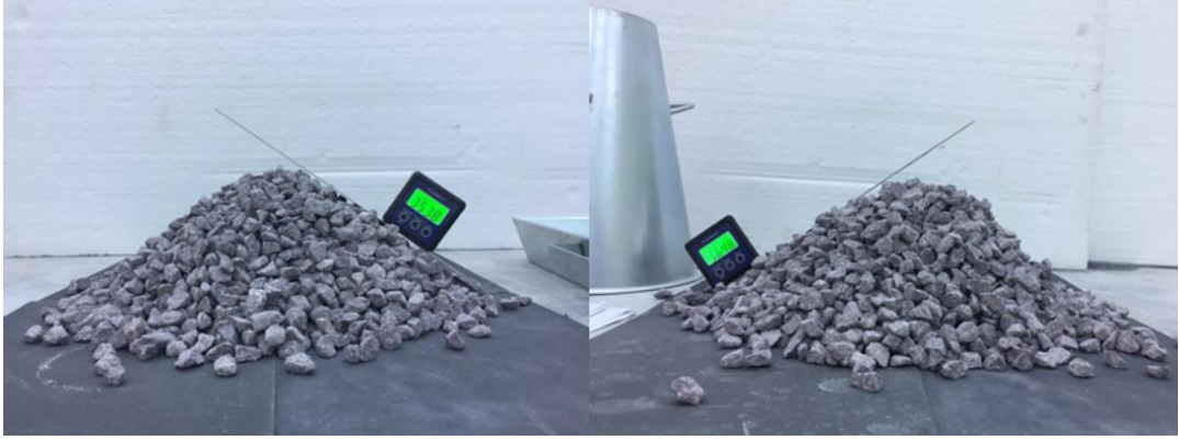
Şekil 3.4: Andezit 10 – 14 mm pürüzlü zeminde şişlenmemiş haldeki duruş açısı.
