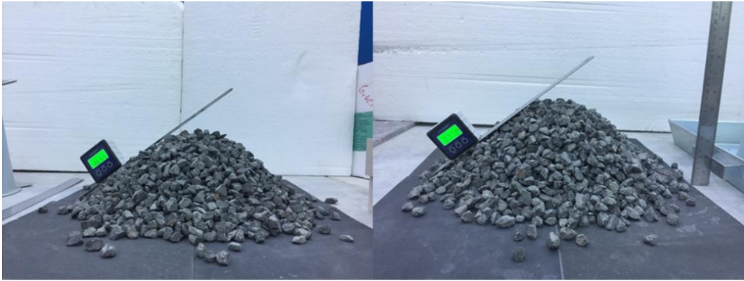
Şekil 3.5: Bazalt 10 – 14 mm pürüzlü zeminde şişlenmemiş haldeki duruş açısı.
