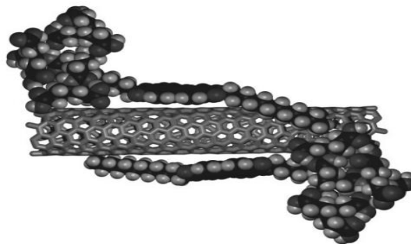
Şekil 1.49: \pi - \pi istiflemeli PDI'lar aracılığıyla kovalent olmayan şekilde işlevselleştirilmiş karbon nanotüp.
