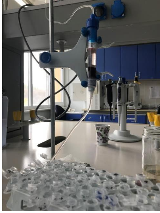
Şekil 2.7: Kolona paketlenmiş jel.
