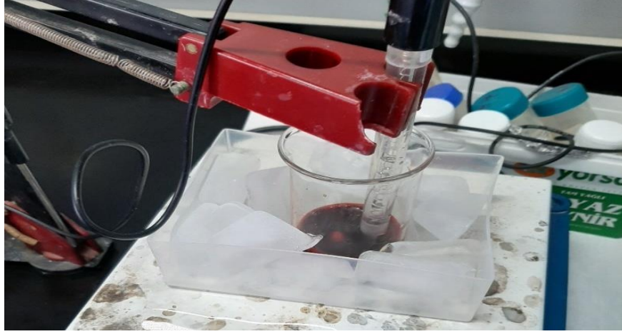
Şekil 2.2: Hemolizatın pH:8,7'ye Tris-Base ile ayarlanması.
