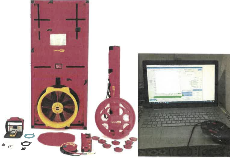
Resim 2.5: BlowerDoor ünitesi bileşenleri ve TEC programı ile ölçüm sonuçlarının kayıt altına alınması [75].
