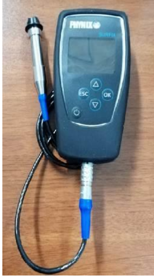
Resim 4.15: Kuru film kalınlığı ölçüm aleti.
