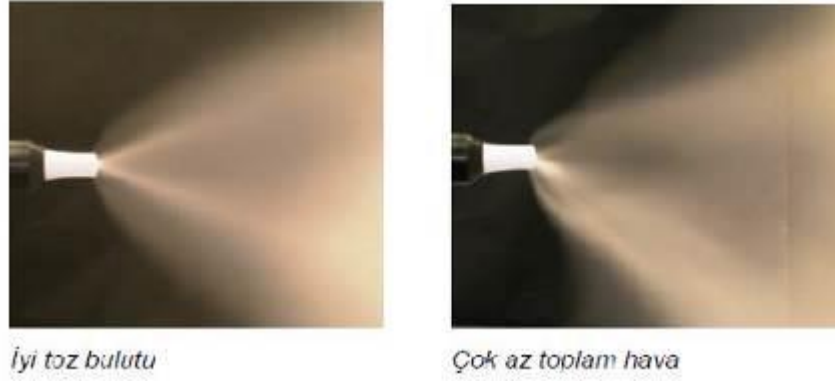
Resim 4.5: Toplam hava debisi ile çıkan toz boya bulutu.
