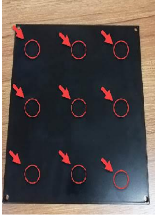
Resim 4.14: Deney parçası üzerinde ölçüm yapılan yerler.
