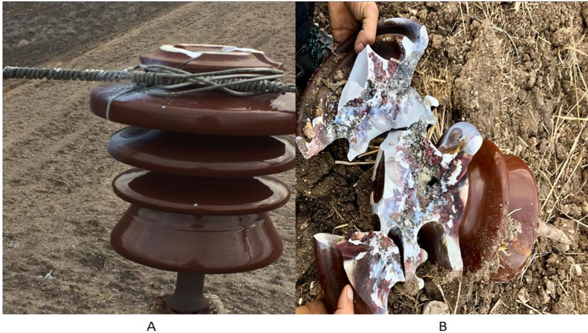
Şekil 3.9: Akçapınar enerji nakil hattında kısmi deşarja neden olan izolatör.
