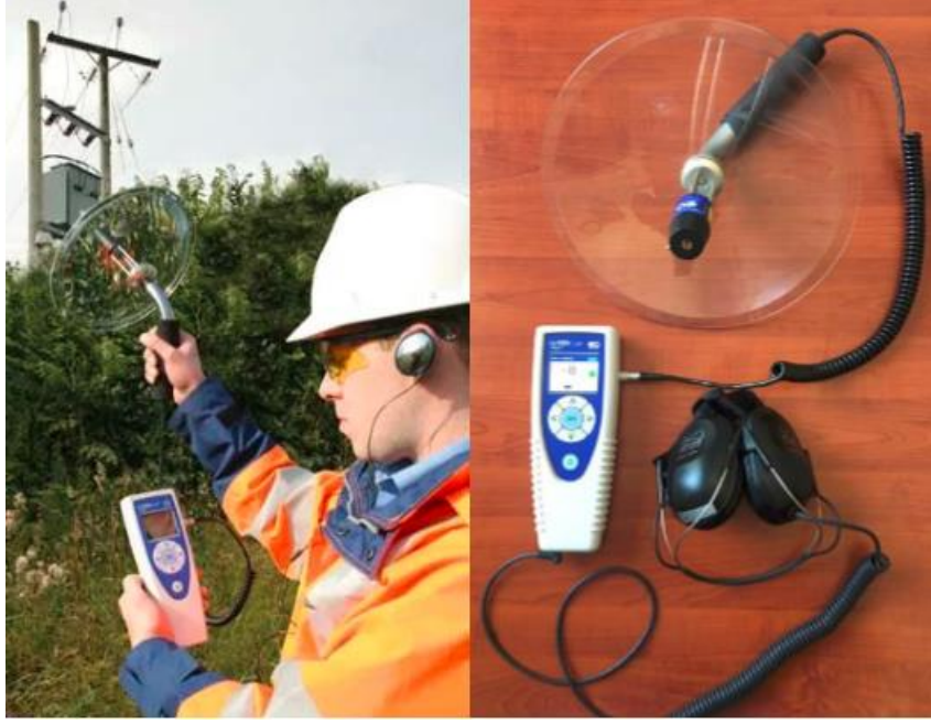
Şekil 3.3: Kısmi deşarj tespit cihazı ile saha etüdü [33].
