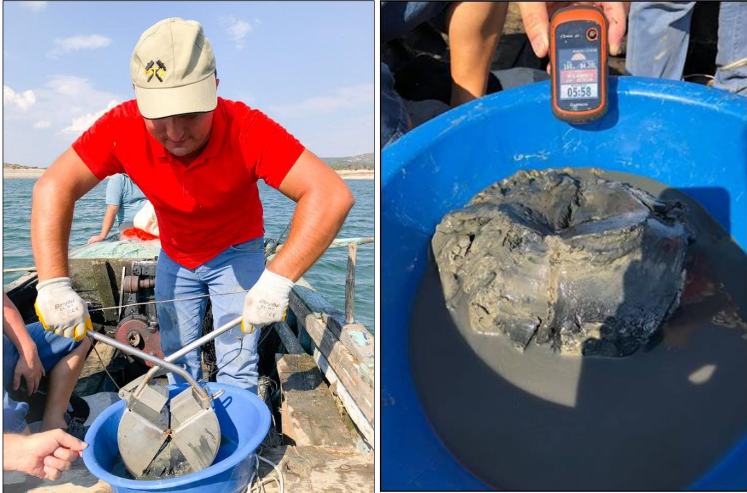
Şekil 7. Yüze Çökelinin Grab'ten Çıkarılması ve Yaş Halinin Görüntüsü
