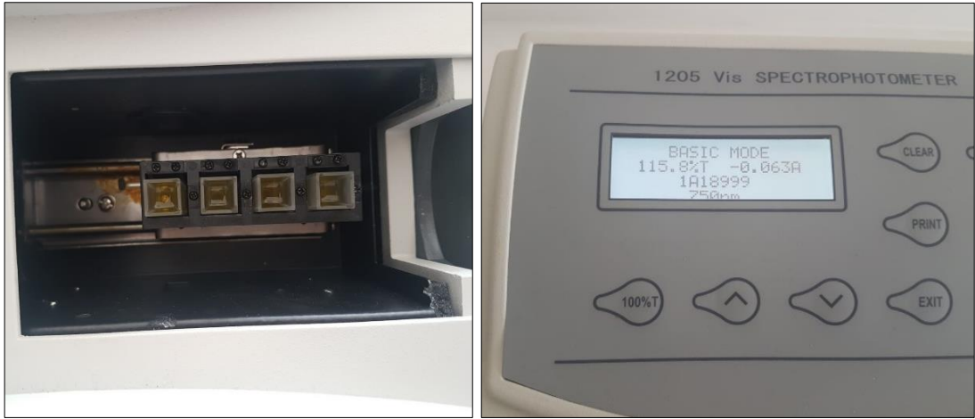
Şekil 23. Spektrofotometre Küvetlerine Doldurulan Çözeltinin 667 ve 750 nm’de Okunması
