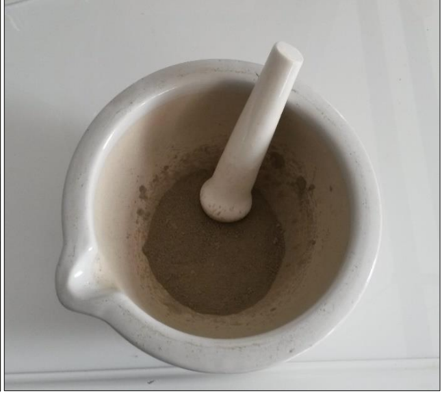
Şekil 10. Örneklerin Porselen Havanda Dövülerek Toz Haline Getirilmesi
