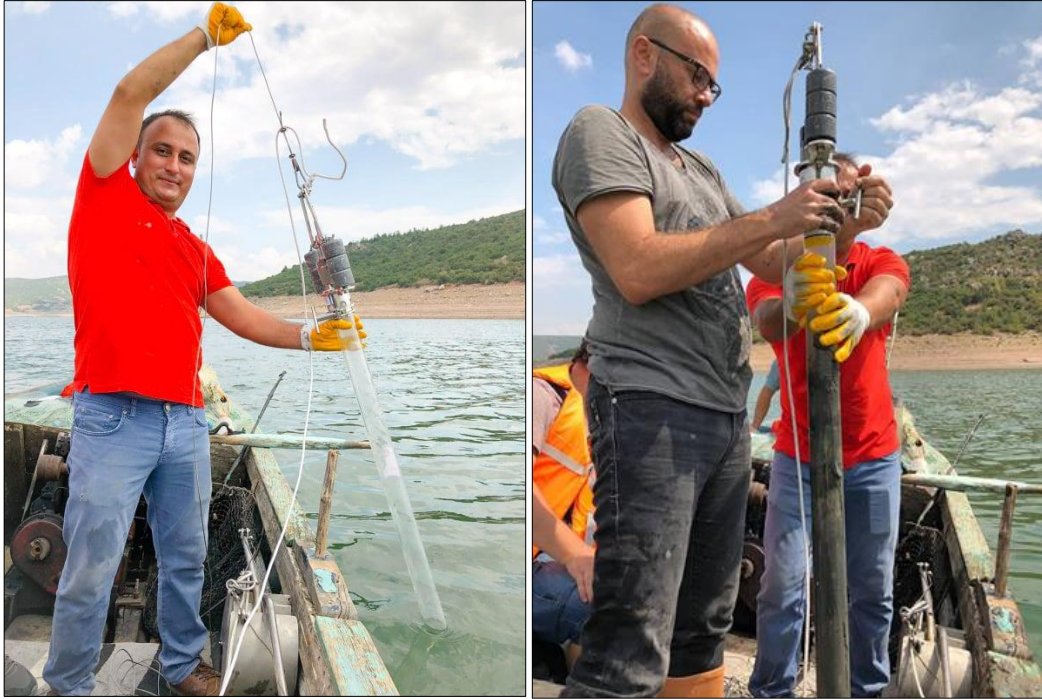
Şekil 5. Kajak Sediment Örnekleyici İle Karot Alınması
