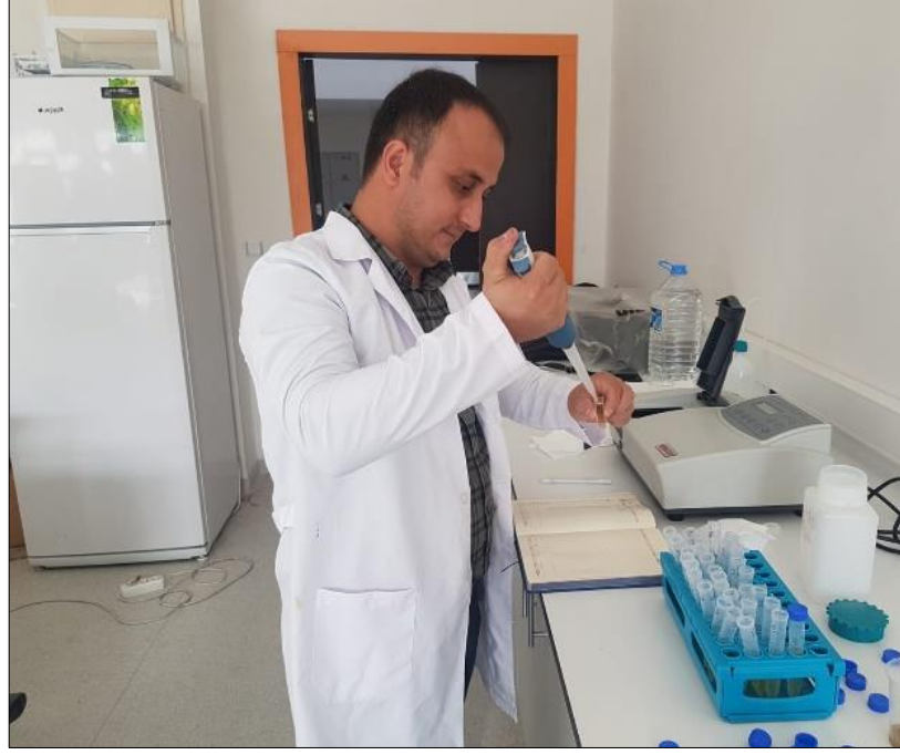
Şekil 22. Aseton Çözeltisinin Spektrofotometre Küvetleri İçerisine Yerleştirilmesi
