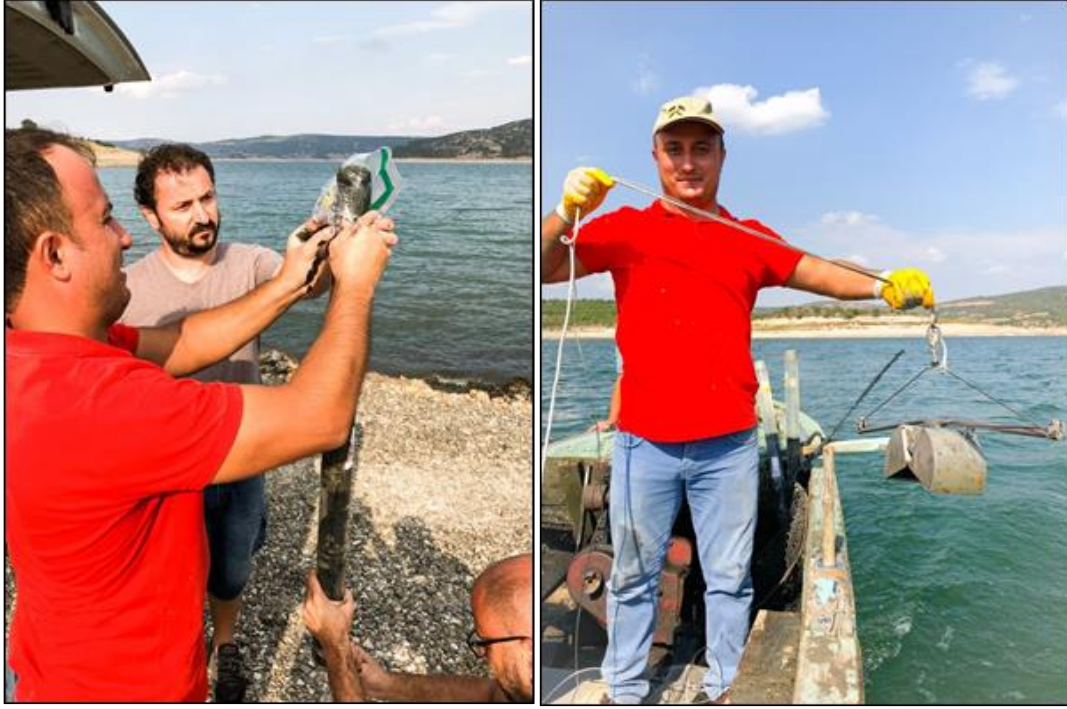
Şekil 6. Karotun Dilimlenmesi ve Yüze Çökeli Almak İçin Van Veen Grab'in Suya Bırakılması
