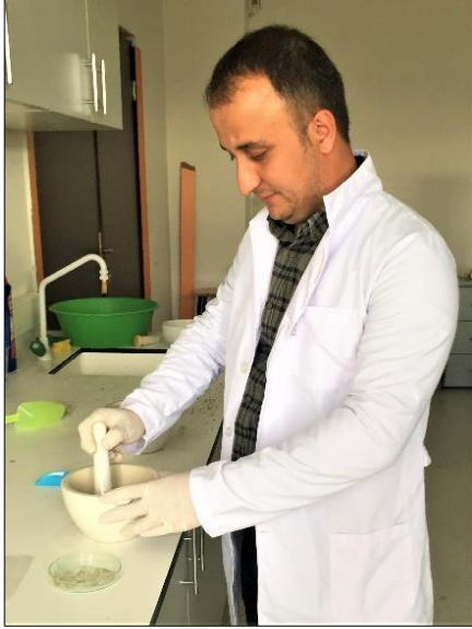
Şekil 10. Örneklerin Porselen Havanda Dövülerek Toz Haline Getirilmesi
