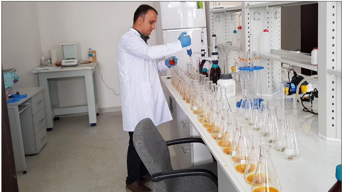
Şekil 12. Erlenlere Otomatik Pipetle Potasyum Dikromat Eklenmesi
