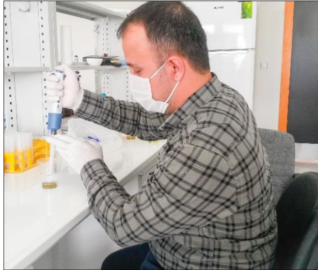
Şekil 19. Pet Bardaktaki Çökel Üzerine Otomatik Pipet İle Aseton Eklenmesi
