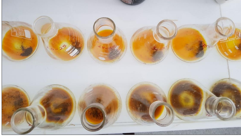
Şekil 13. Çökel ve K_2Cr_2O_7 'nin Karıştırılmış Hali
