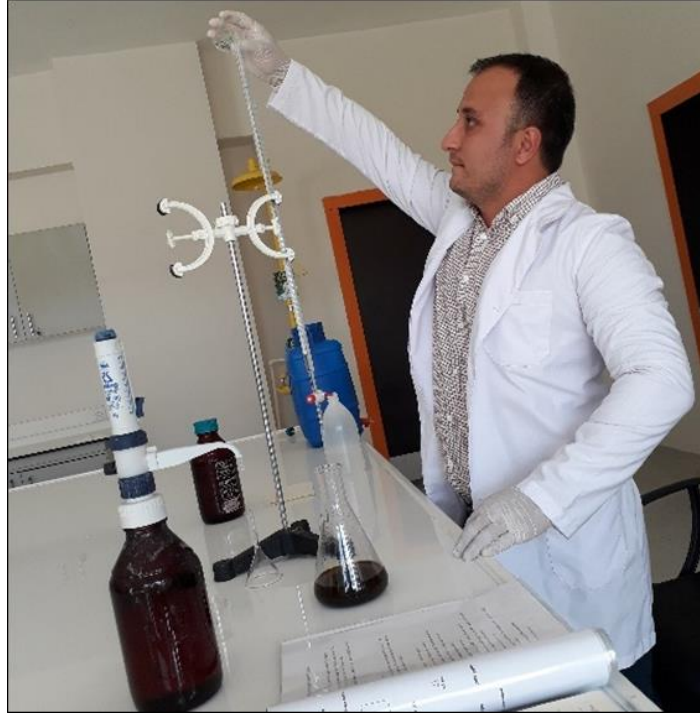
Şekil 15. Bürete (\text{NH}_4)_2 \text{Fe}(\text{SO}_4)_2 \cdot 6\text{H}_2\text{O} (demir amonyum sülfat) Çözeltisinin Doldurulması
