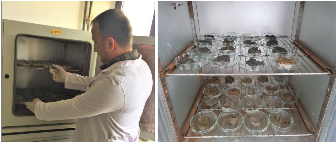
Şekil 8. Örneklerin Etüve Yerleştirilmesi ve 24 Saat 60^{\circ}C 'de Kurutma İşlemi
