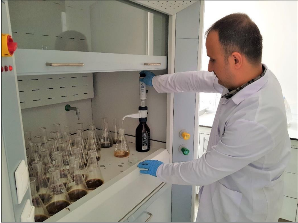
Şekil 14. Erlenler İçerisindeki Çökellerin üzerine Çeker Ocakta H_2SO_4 Eklenmesi
