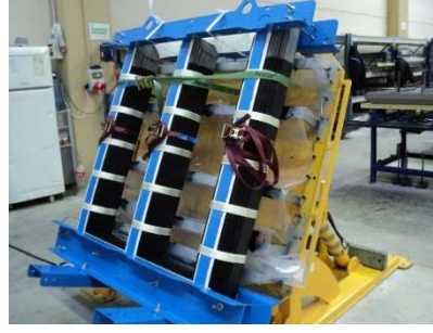
Şekil 24. Üst Boyunduruk Sacının Çelik Parçalar ile Sabitlenmesi
