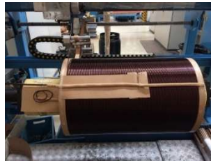
Şekil 16. Emay İzoleli Yuvarlak Bakır Tel ile YG Bobini Sarımı
