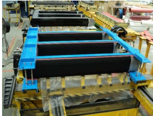
Şekil 13. Çelik Parça Montajları Tamamlanmış Bir Nüve
