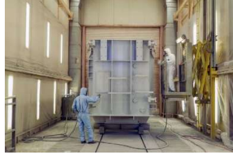
Şekil 22. Boyahanedeki Bir Transformatör Kazanı
