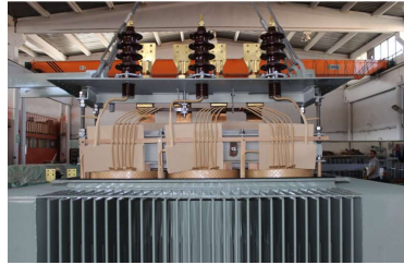
Şekil 28. Fırından Çıkan Bir Aktif Kısımın Kazana İndirilmesi
