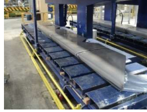
Şekil 9. Kesilip Dilinen Silisli Sac Demetleri
