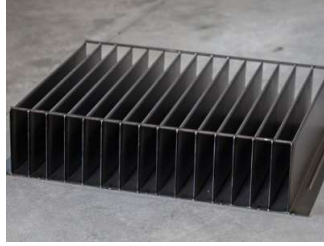
Şekil 19. İmalatı Tamamlanmış Bir Dalga Duvar
