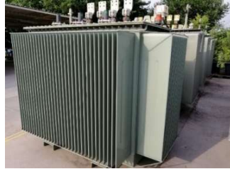
Şekil 20. Dalga Duvarlı Bir Transformatör Kazanı
