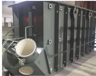
Şekil 21. Düz Duvarlı Bir Transformatör Kazanı
