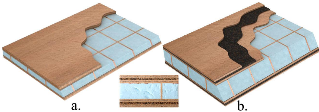
Şekil 1.25: a) Ahşap petekli köpük çekirdek yapıya sahip okume dış tabakalı sandviç yapı, b) ahşap petekli köpük çekirdek yapıya sahip kauçuk mantar ara tabakalı, okume dış tabakalı, sandviç yapı.
