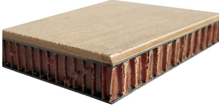
Şekil 1.22: Nomex balpeteği çekirdek malzemeye sahip ahşap dış tabakalı sandviç yapı.
