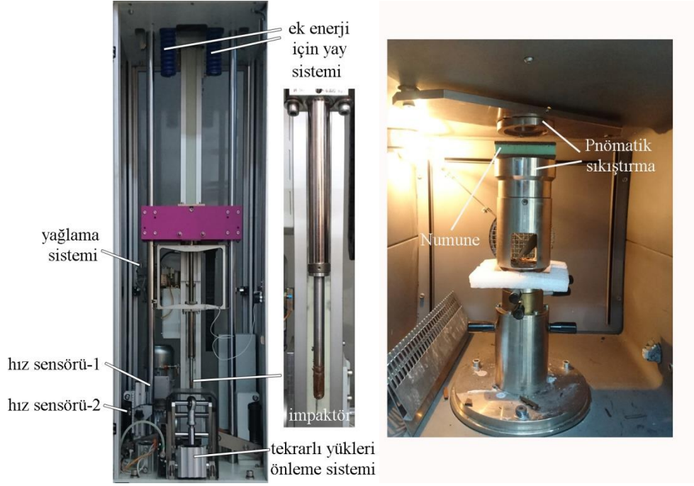
Şekil 5.5: Instron CEAST Fractovis Plus-7526 test cihazı kısımları.
