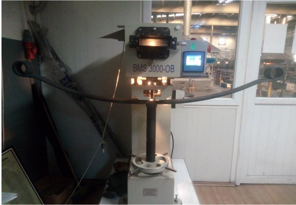
Şekil 7.4: Numunenin brinell sertlik değerinin ölçülmesi.
