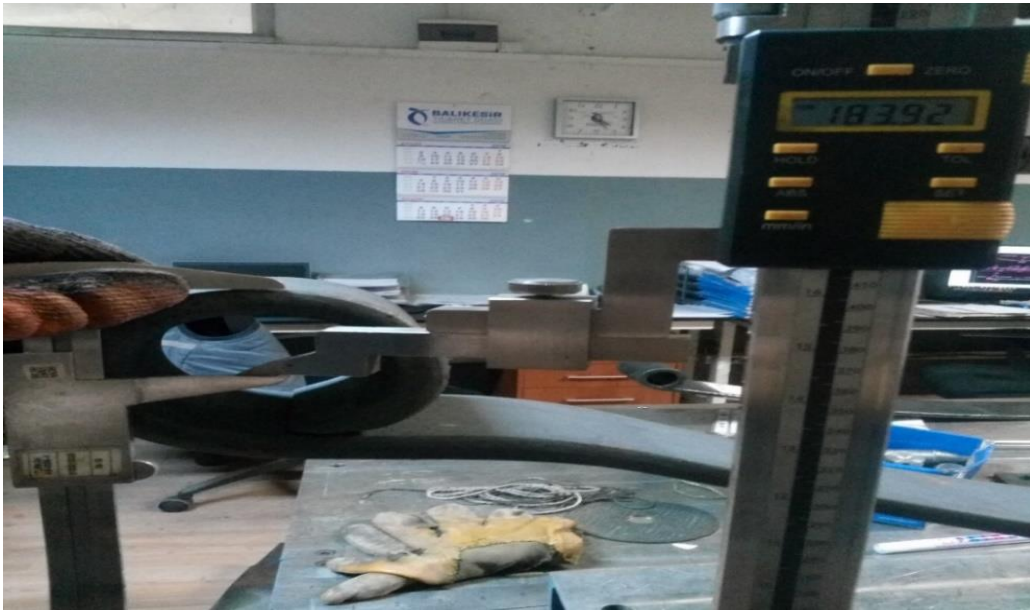
Şekil 7.5: Kavis 138 mm olan göz tarafının kavisinin 183 mm yapılmış hali.
