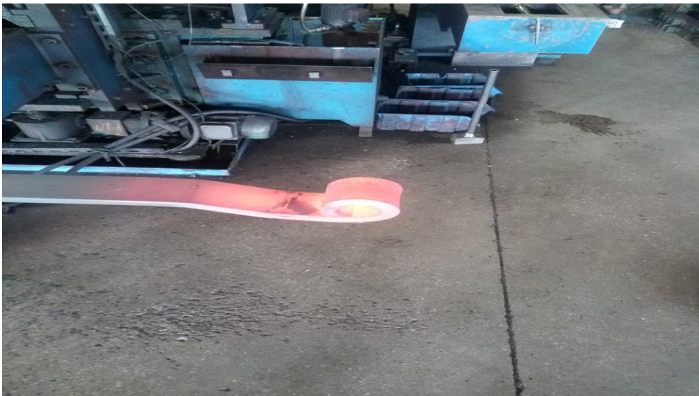
řekil 5.4: Gz kıvrma iřlemi sonucunda oluřan gz [20].
