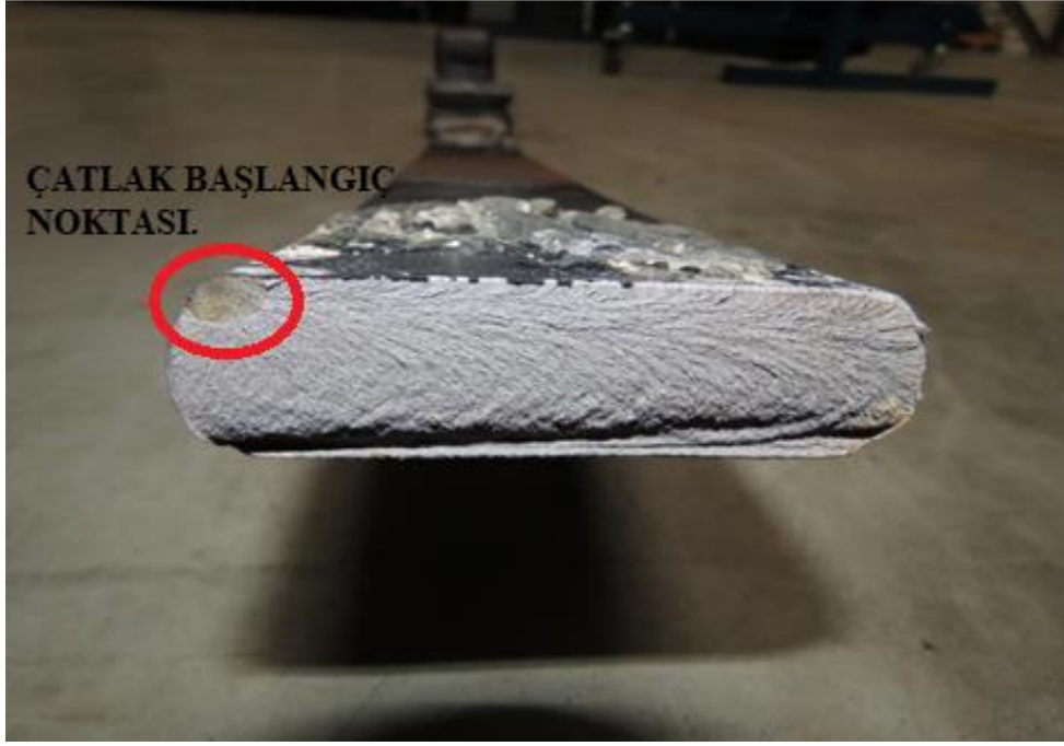
Şekil 7.21: Stresli kumlama işlemi uygulanmış numunenin kırılma yüzeyi.
