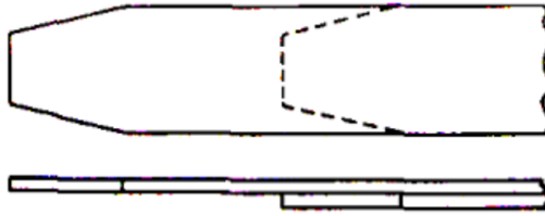
Şekil 2.19: Üçgen kesim bıçakları ile kesilmiş mızrak uç.
