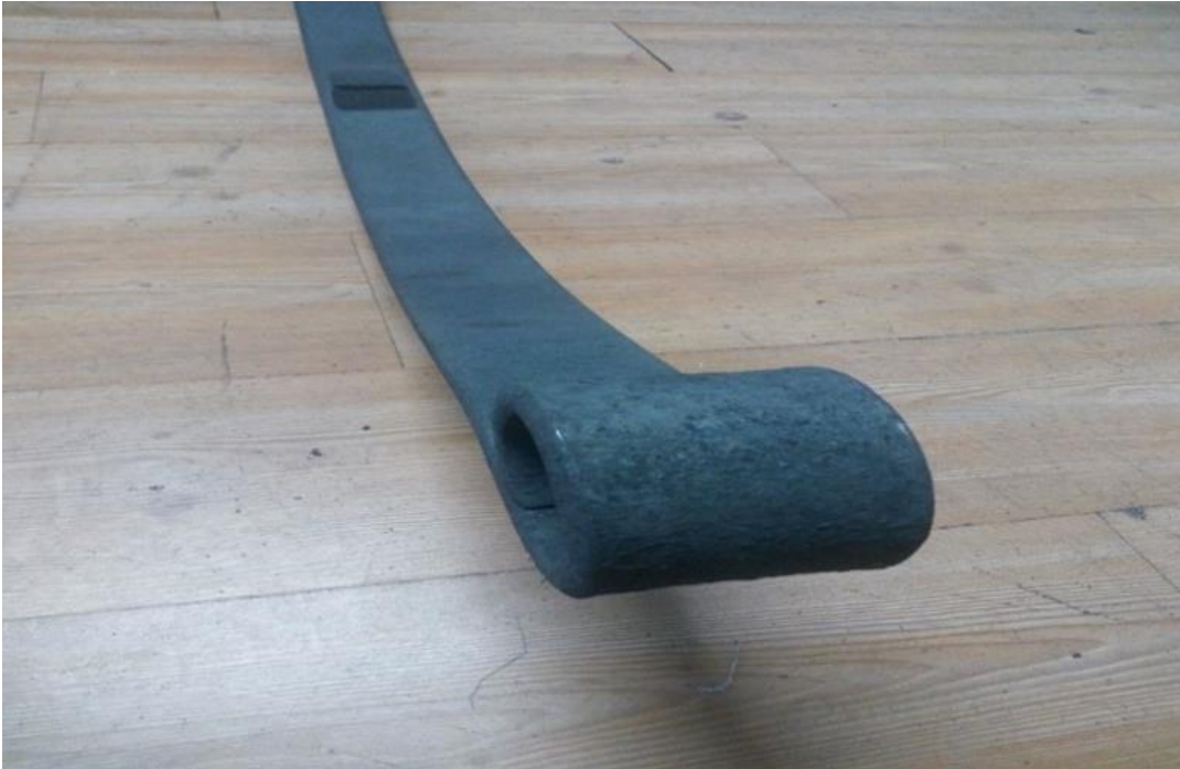
Şekil 7.10: Kumlama öncesi yaprak yay görünümü.
