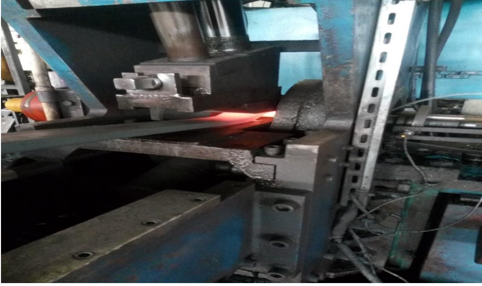
řekil 5.3: Gz kıvrma iřlemi yapılırken [20].
