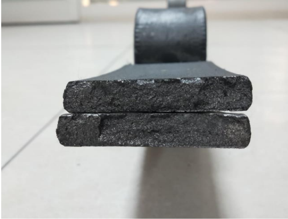
Şekil 7.22: Herhangi bir kumlama işlemi uygulanmamış numunenin kırılma yüzeyi.
