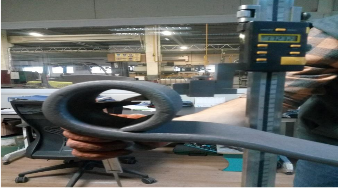
Şekil 7.6: Kavisi 128 mm olan göz tarafının kavisininin 173 mm yapılmış hali.
