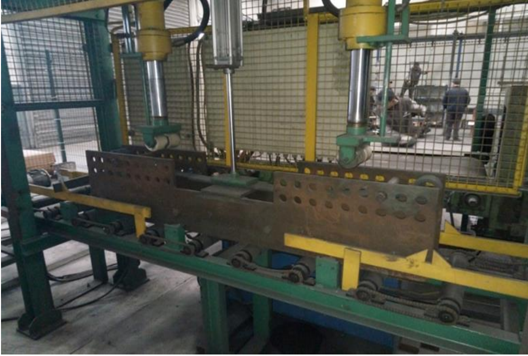
Şekil 7.9: Stresli kumlama işlemini için makas germe işleminin görseli.
