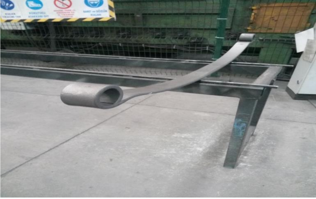
Şekil 7.11: Kumlama sonrası yaprak yay görünümü.
