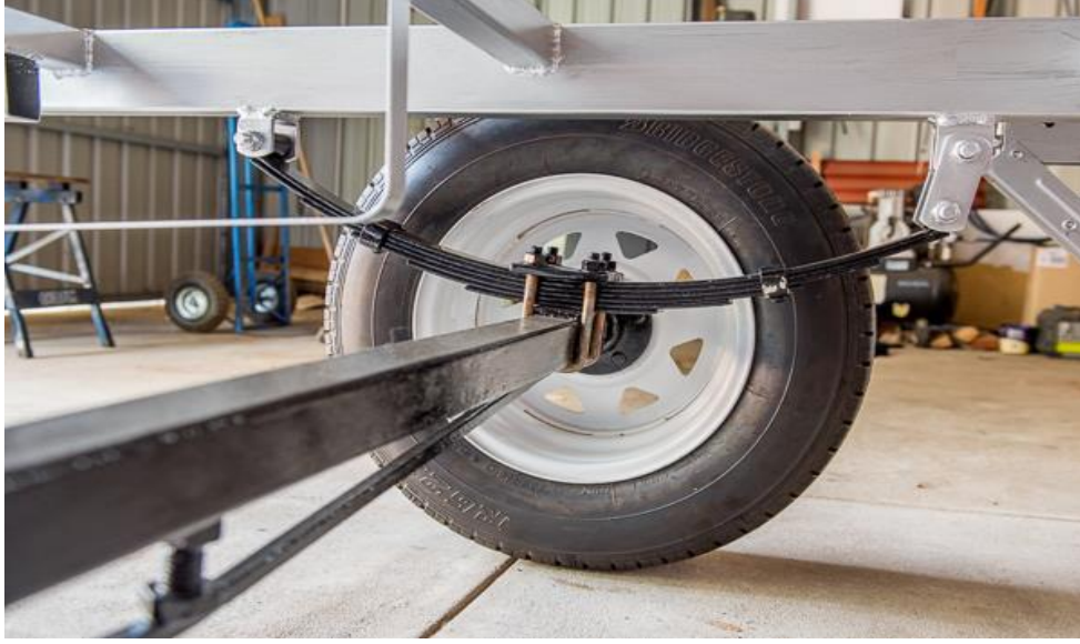
Şekil 3.1: Araç altına bağlanmış yaprak yay örneği [20].
