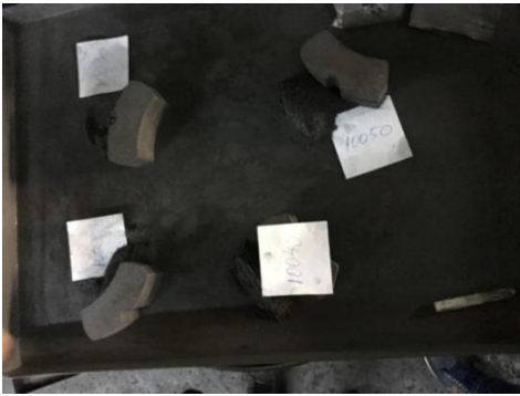
Şekil 6.18: 100 µm.lik numuneler-pişirme presi öncesi
