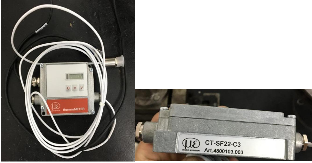
Şekil 6.6: Kızılötesi sensörlü nokta ölçüm termometre.
