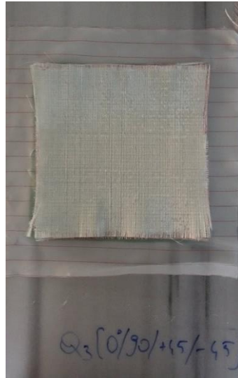
Şekil 4.4: Soyma kumaşı ve elyafların dizilimi.
