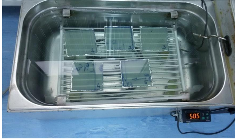
Şekil 4.12: 100x100 numunelerin su banyosunda şartlandırılması.
