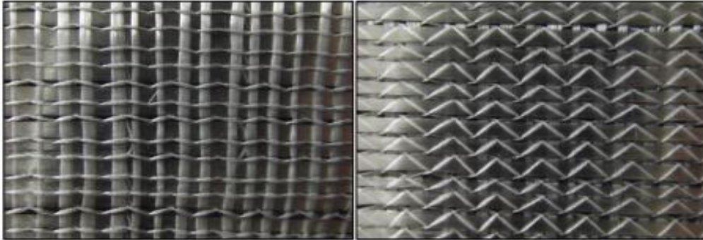
Şekil 4.1: Metyx L300-E10C cam elyaf kumaş görüntüsü [53].
