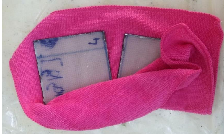
Şekil 4.14: 100x100 numunelerin ölçümden önce kurutulması.
