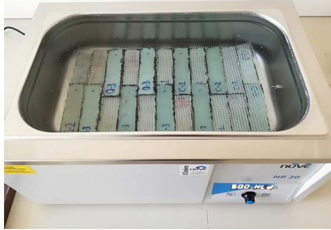
Şekil 4.17: Numunelerin su banyosunda şartlandırılması.
