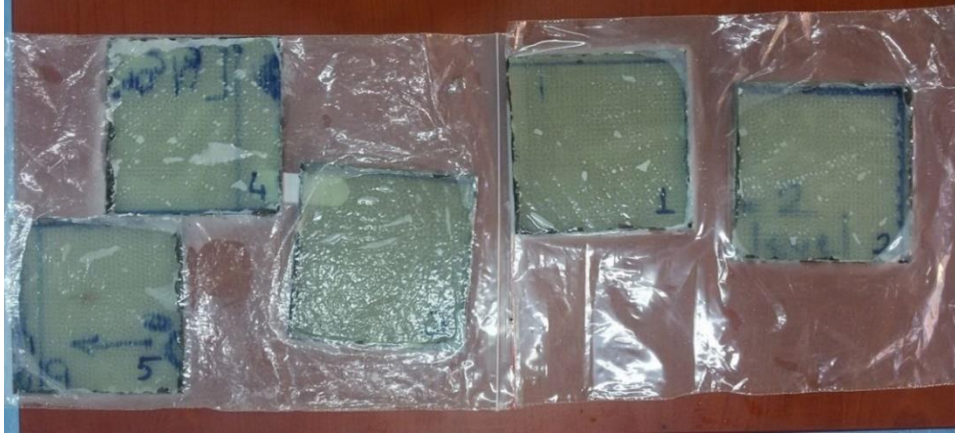
Şekil 4.13: 100x100 numunelerin torbalarda bekletilme şekli.
