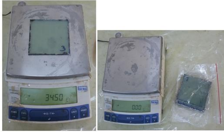
Şekil 4.15: 100x100 numunelerin kütlelerinin ölçümü.
