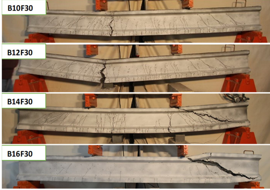
Şekil 4.21: B grubu 30 mm makro lifli kirişlere ait kırılma şekilleri.
