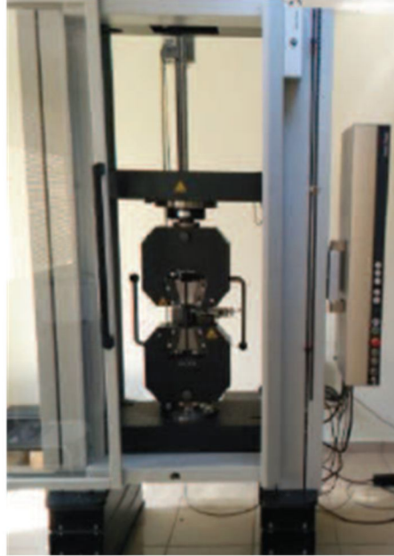
Şekil 3.2: Aksenal çekme test düzeneği.
