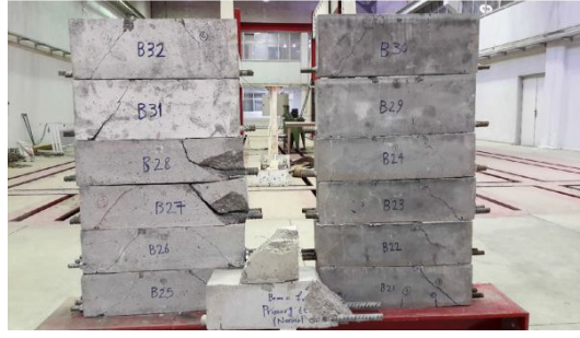
Şekil 1.8: Kirişlerin kırılma şekilleri [25].
