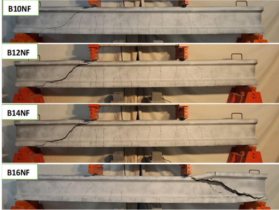
Şekil 4.19: B grubu NF kirişlere ait kırılma şekilleri.
