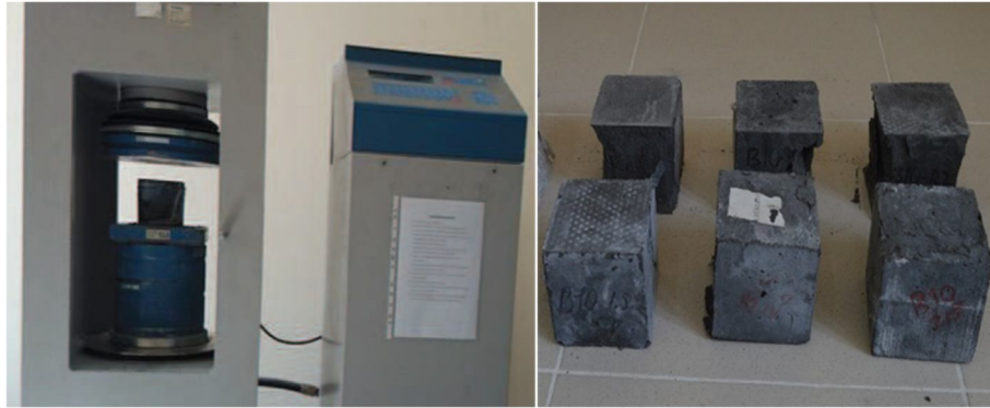
Şekil 3.1: Beton basınç test düzeneği (sol) ve küp numuneler (sağ).
